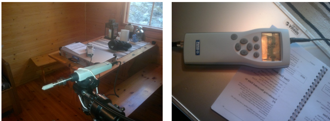
Figur 12: Mätinstrumentet som användes vid mätningen av inneluftens temperatur och relativa fuktighet för januari månad 2013.
