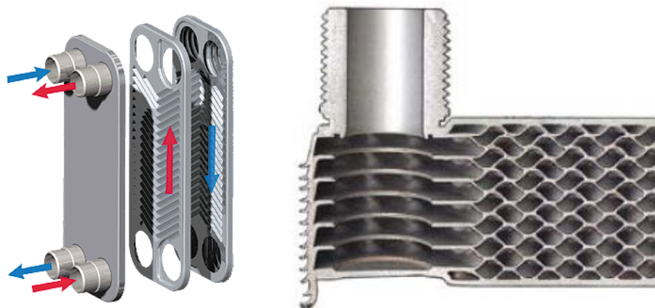
KUVA 10. Levylämmönsiirrin höyrystimenä, lauhduttimena ja tulistuksenpoistosiirtimenä /18;17/
