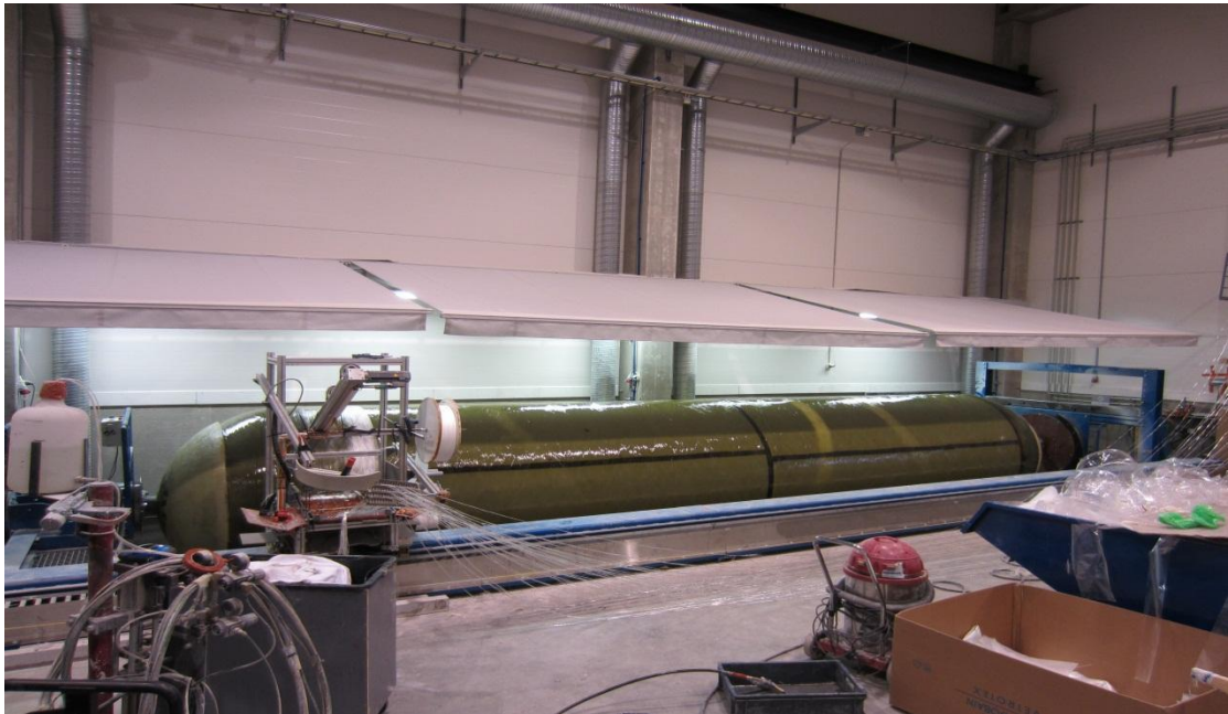
KUVA 3. Kuitukelauksen periaate (Admor Composites Oy.)
