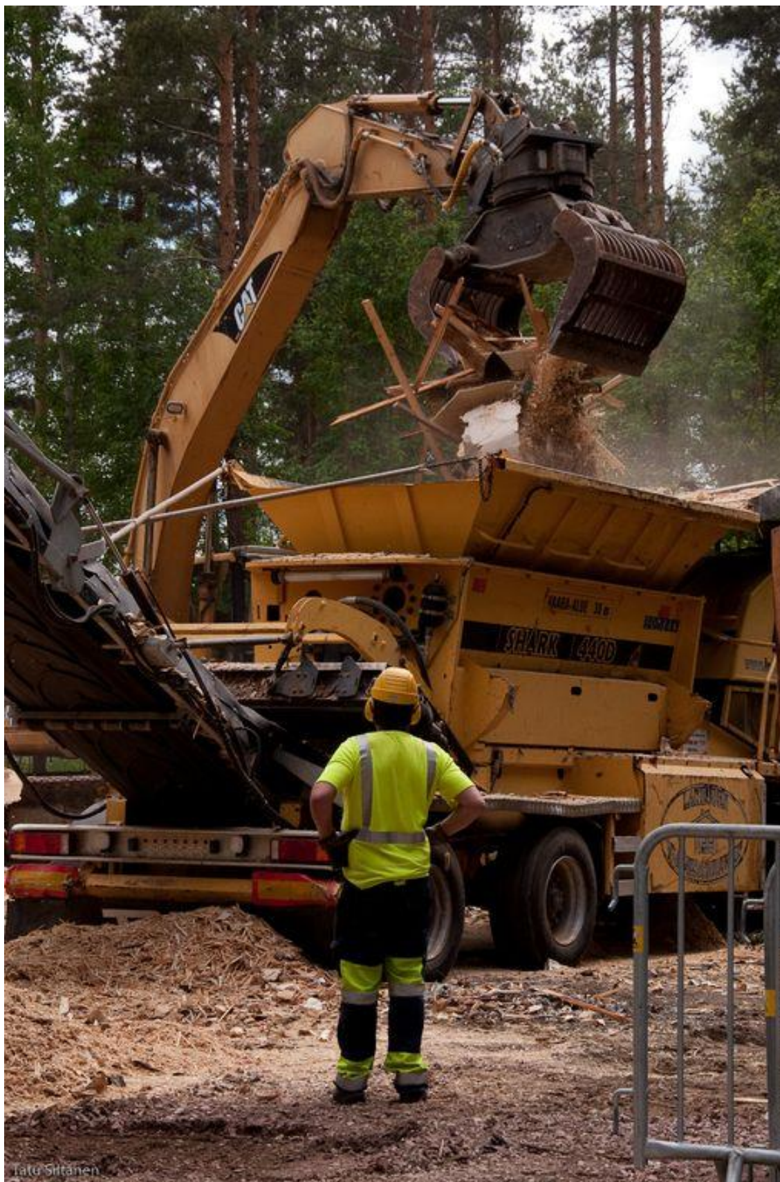
Kuva 28. Jäte siirtyy jätteenrepijältä kuljettimelle, joka siirtää jätteen murskattuna lavalle [21]
