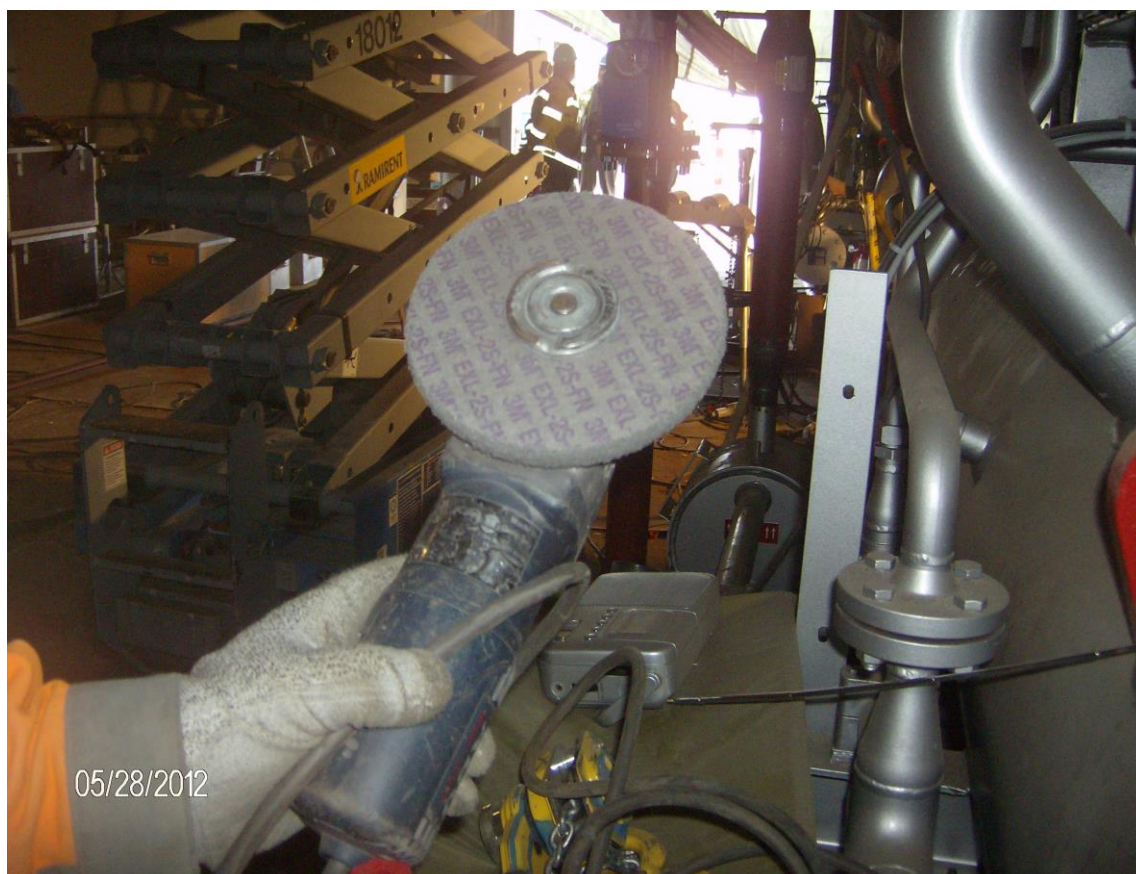
Kuva 13. Kulmahiomakoneesta puuttuu suojat [27]
