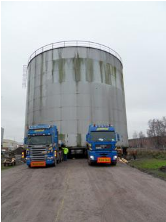
Kuva 3. Vesisäiliön siirto Ruotsissa kahdella Havatorin kuljetusautolla (Havatorin www-sivut 2013, hakupäivä 27.1.2013)
