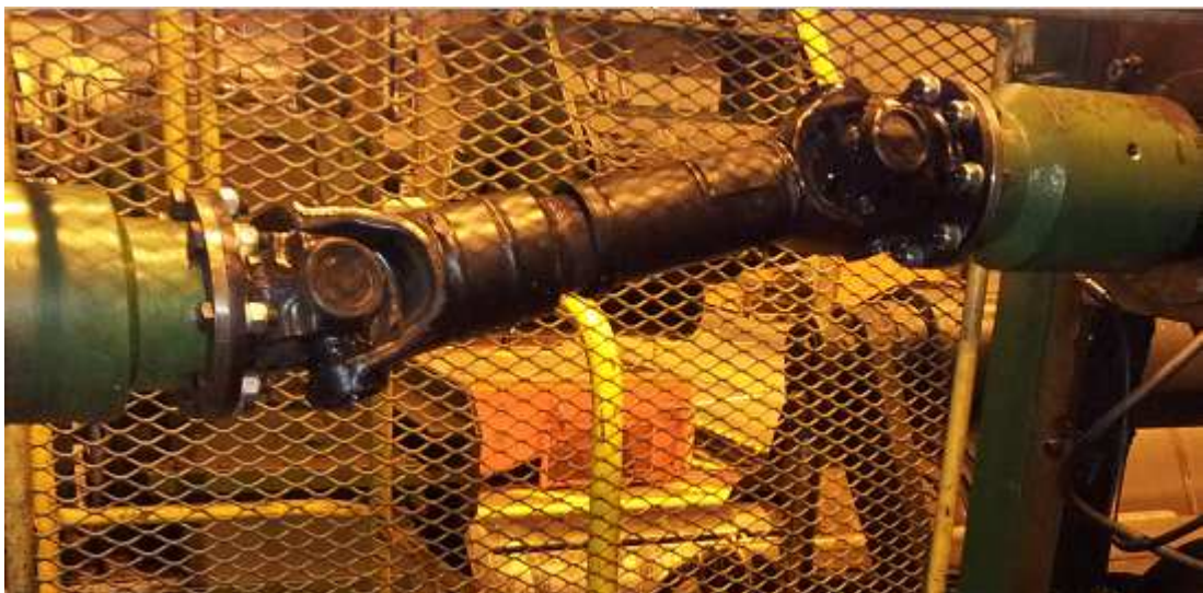
Kuva 11. Vetorullasto 1 ylärullan nivelakseli.
