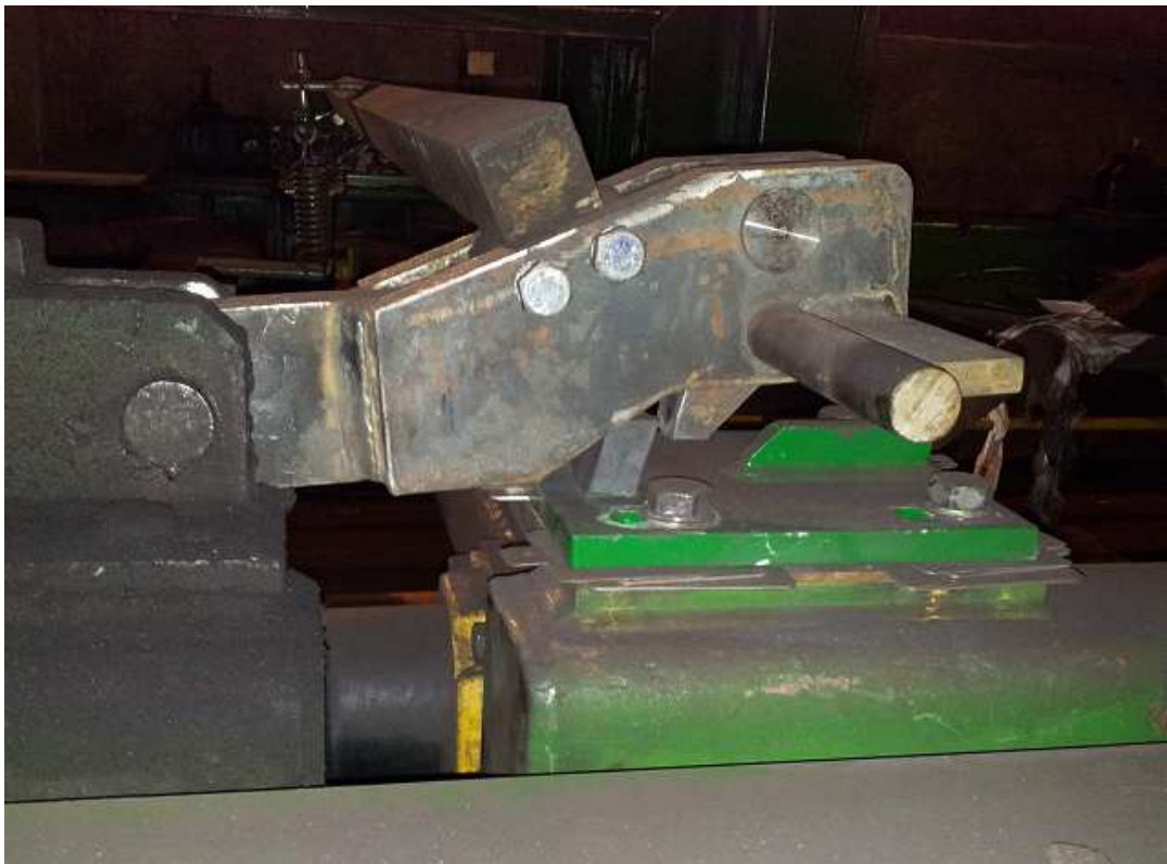
Kuva 11. Varaaja 1 välivaunujen kiinnitysmekanismi.
