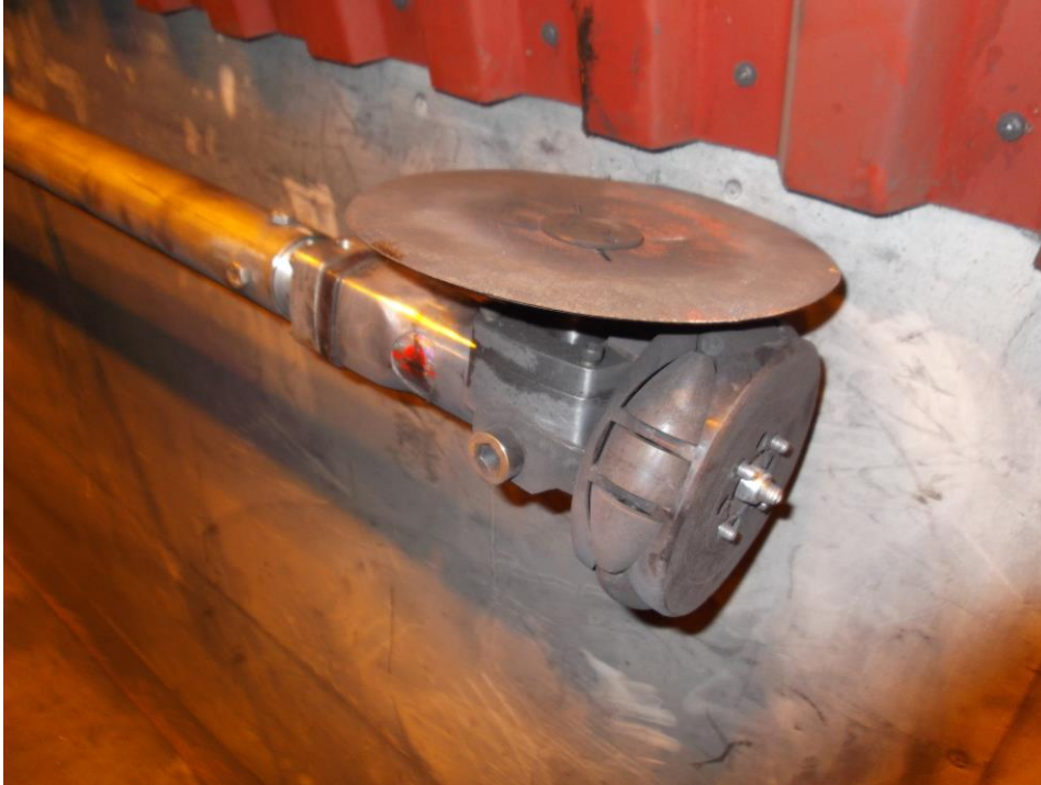
KUVA 7. Paineilmakäyttöinen jatkovarsihiomalaite, nauhalevyleikkauslinja 2
