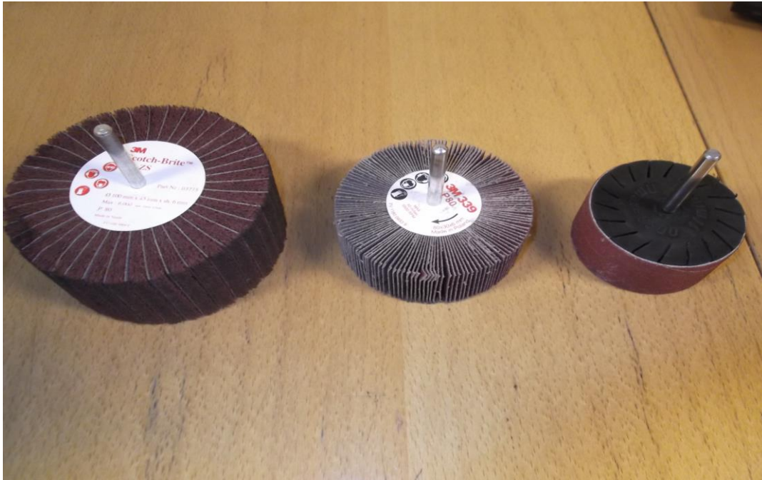
KUVA 12. Jatkovarrellisen karahiomakoneen hiontapäät testauksessa
