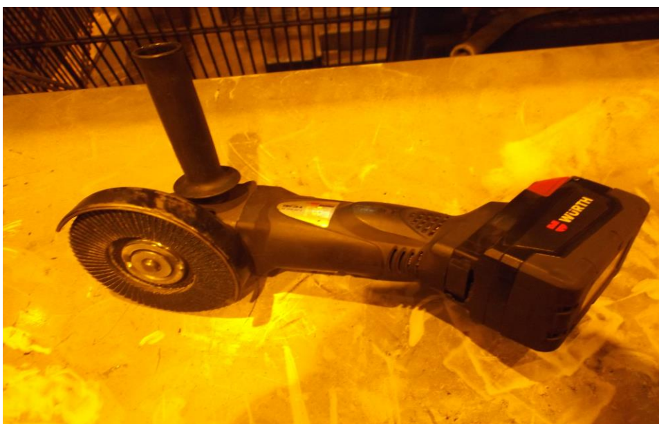
KUVA 9. Sähkökäyttöinen kulmahiomakone, jossa lamellilaikka. 10.4.2013
