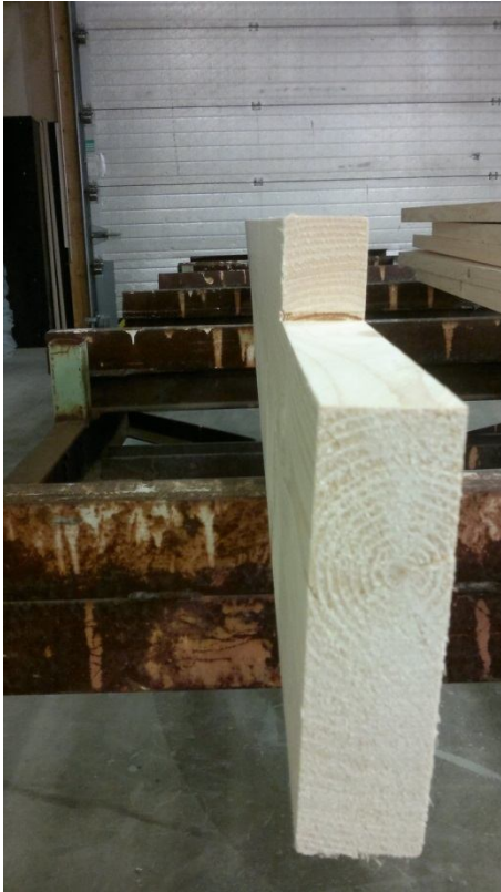
KUVA 9. Pituusakselinsa ympäri kiertynyt runkotolppa
