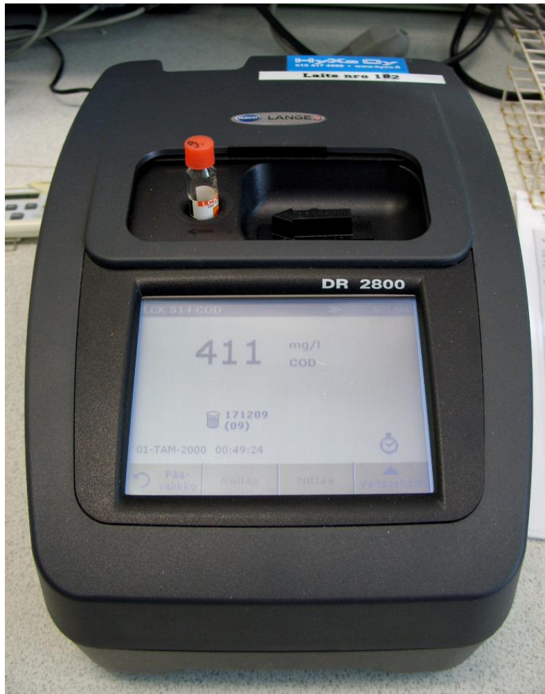
KUVA 5. Hach DR 2800 -spektrofotometri (Heini Hämäläinen 2013)
