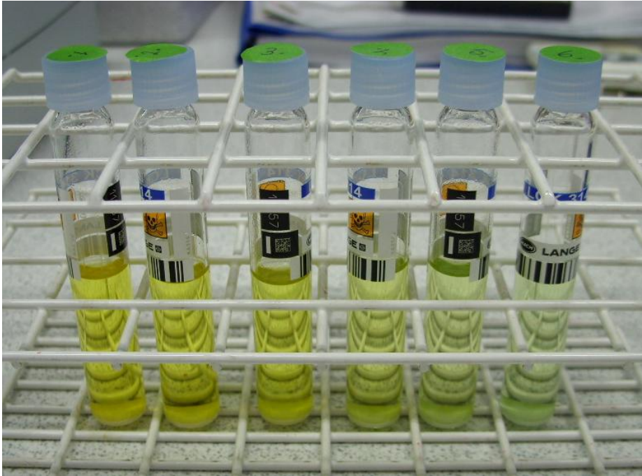
KUVA 6. LCK 314 -putkien kalibrintiliuokset hapetuksen jälkeen (Heini Hämäläinen 2012)
