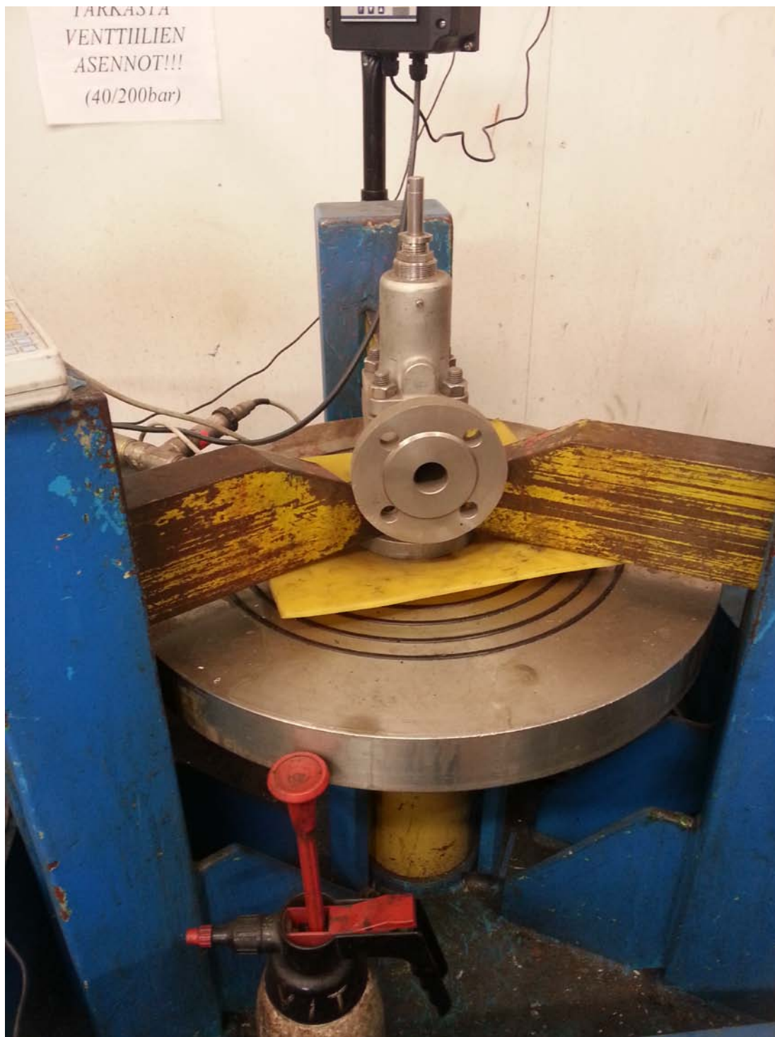
Kuva 2. Varoventtiili asetetaan kiinnitysleukojen väliin, tarvittavat kaapelit kytetään ja painetta lähdetään nostamaan. Kun asetuspainne ylittyy, toimiva varoventtiili avautuu.
