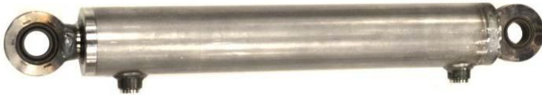
Kuva 11. Nostimeen soveltuva hydraulisyliinteri jossa iskun pituus on 500 mm. Männän halkaisija 30 mm, sylinterin kokonaishalkaisija 50 mm ja työntövoima 160 barin paineella 31kN [10]
