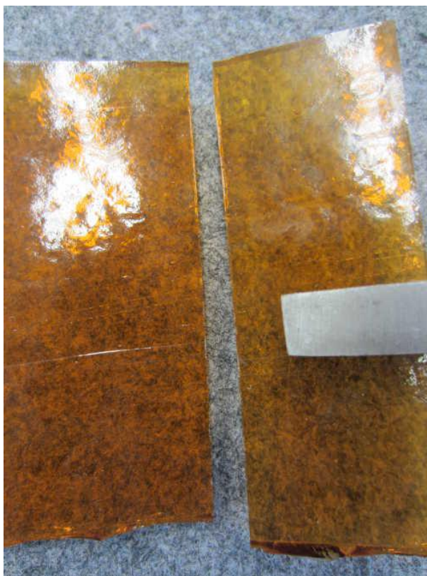
KUVA 5. Lasin leikkaaminen lasilevystä lasinkatkaisupihdeillä. Riikka Vasko 2013
