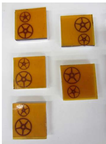
KUVA 13. Lasipalaset menossa yhteensulatuspoltttoon. Riikka Vasko 2013
