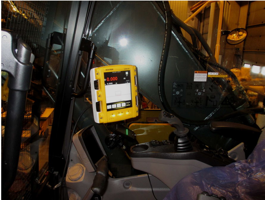
KUVA 14. Novatron Vision 3D –koneohjausjärjestelmän näyttölaite
