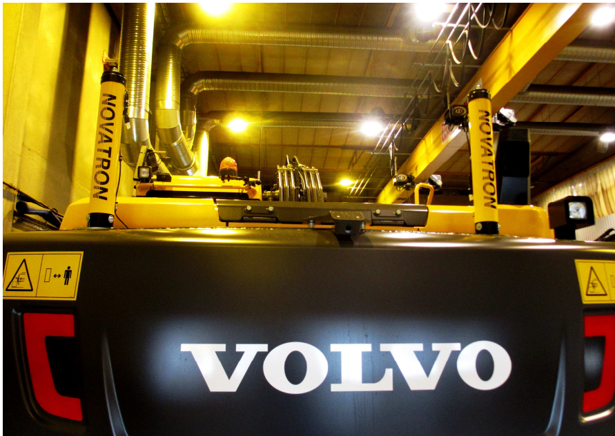
KUVA 15. Antennimastot kaivukoneen takaosassa
