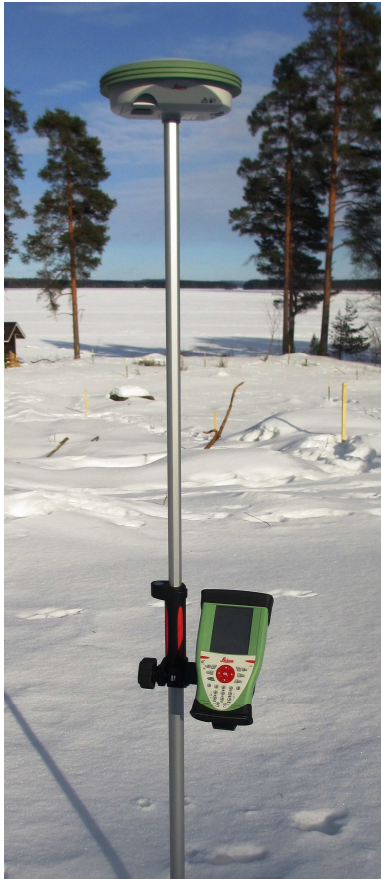
KUVA 7. RTK-mittauksissa käytettävä paikantava vastaanotin ja maastotietokone kartoitussauvassa
