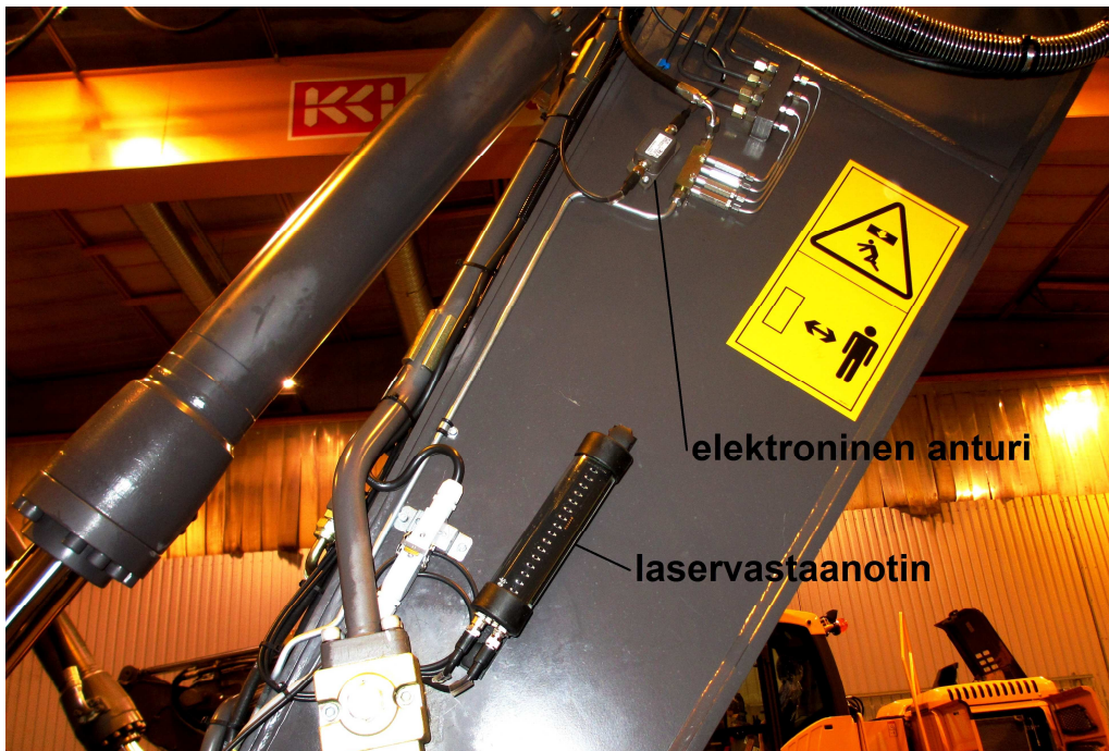
KUVA 13: Elektroninen anturi ja laservastaanotin kaivukoneen kaivuvarressa
