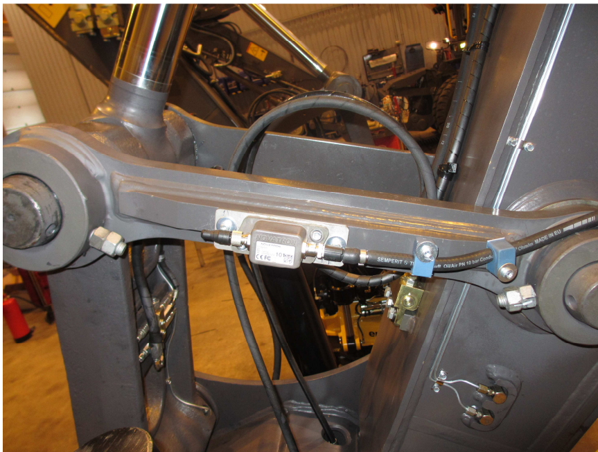
KUVA 12. Elektroninen CAN-anturi kaivukoneessa
