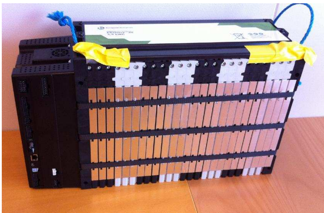
KUVA 5. Esimerkki akusta, jossa on sarjaan ja rinnan kytkettyjä kennoja (Jani Rissanen 2013.)
