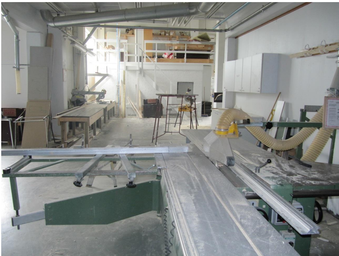
Kuva 2 Tarkkuussirkkeli ja kaappasirkkeli sekä suunniteltu katkaisu- ja työstöharjoittelualue
