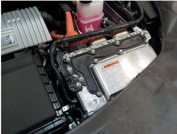
Kuva 22. Invertterin suojakansi paikallaan
