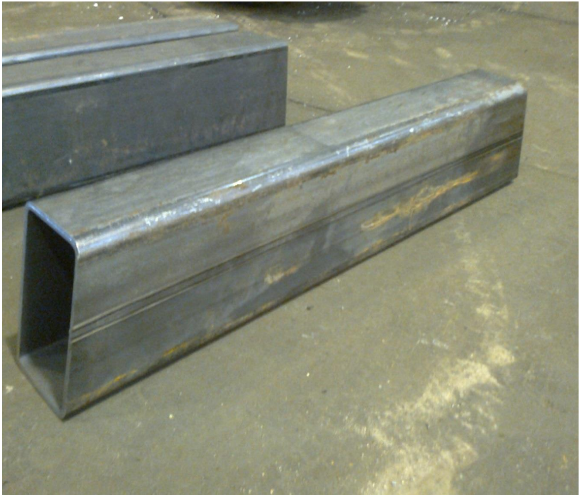
Nostimen rungon tukipalkki
