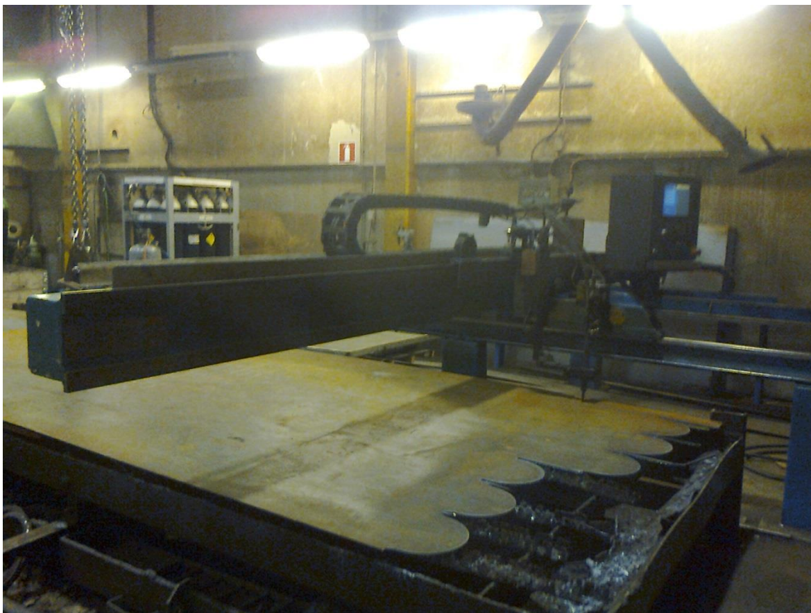
Polttoleikkauksiin käytettävä polttoleikkausautomaatti
