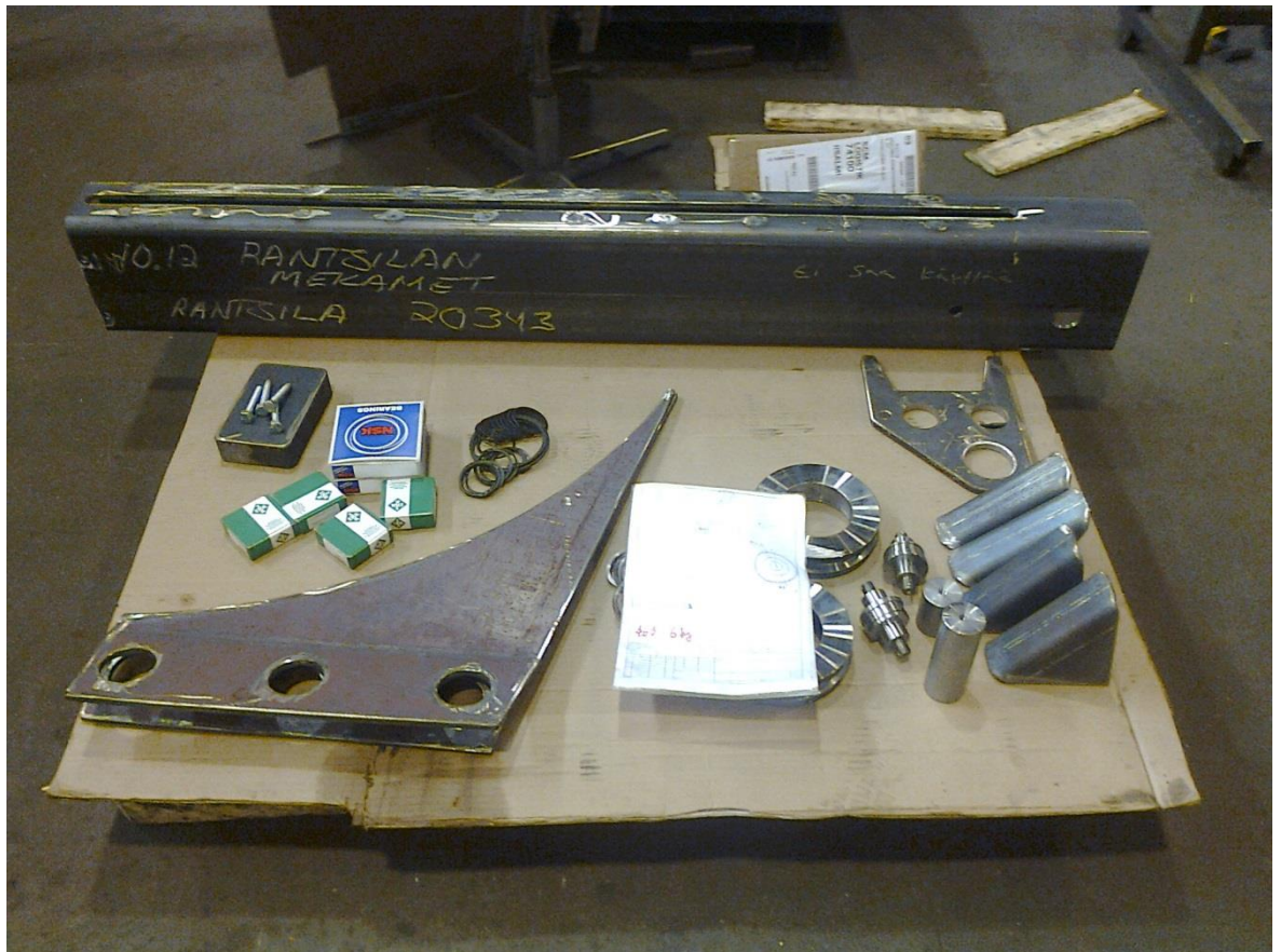
Nostimen rungon jäykisteet, puomi, puomin päätylappupaino, kelkka osineen sekä hydraulisyylinterin osia
