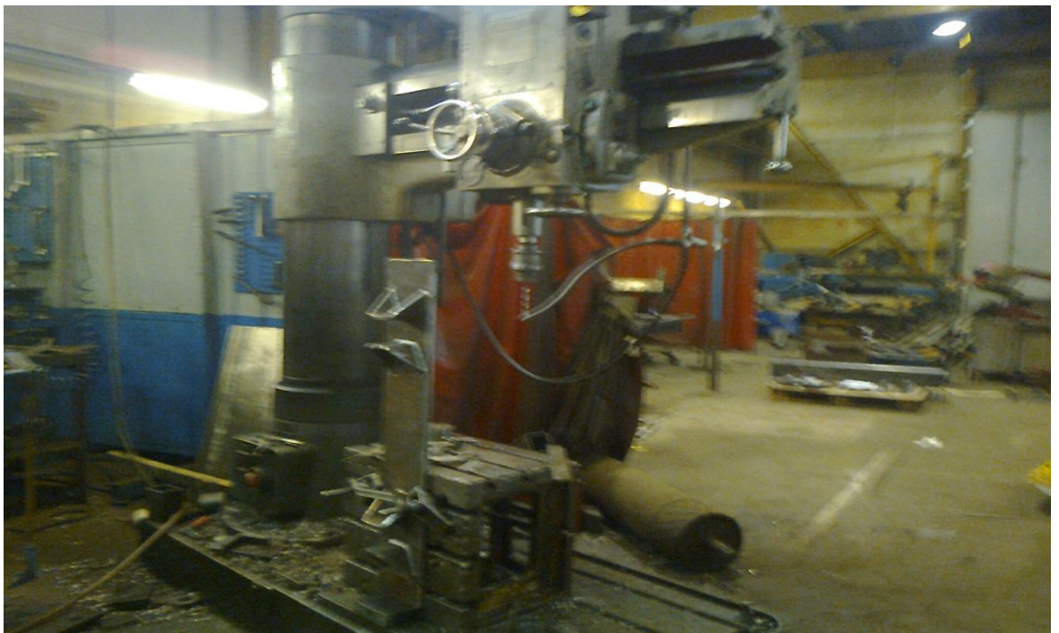
KUVIO 20. Akselien reikien poraukseen käytettävä pora
