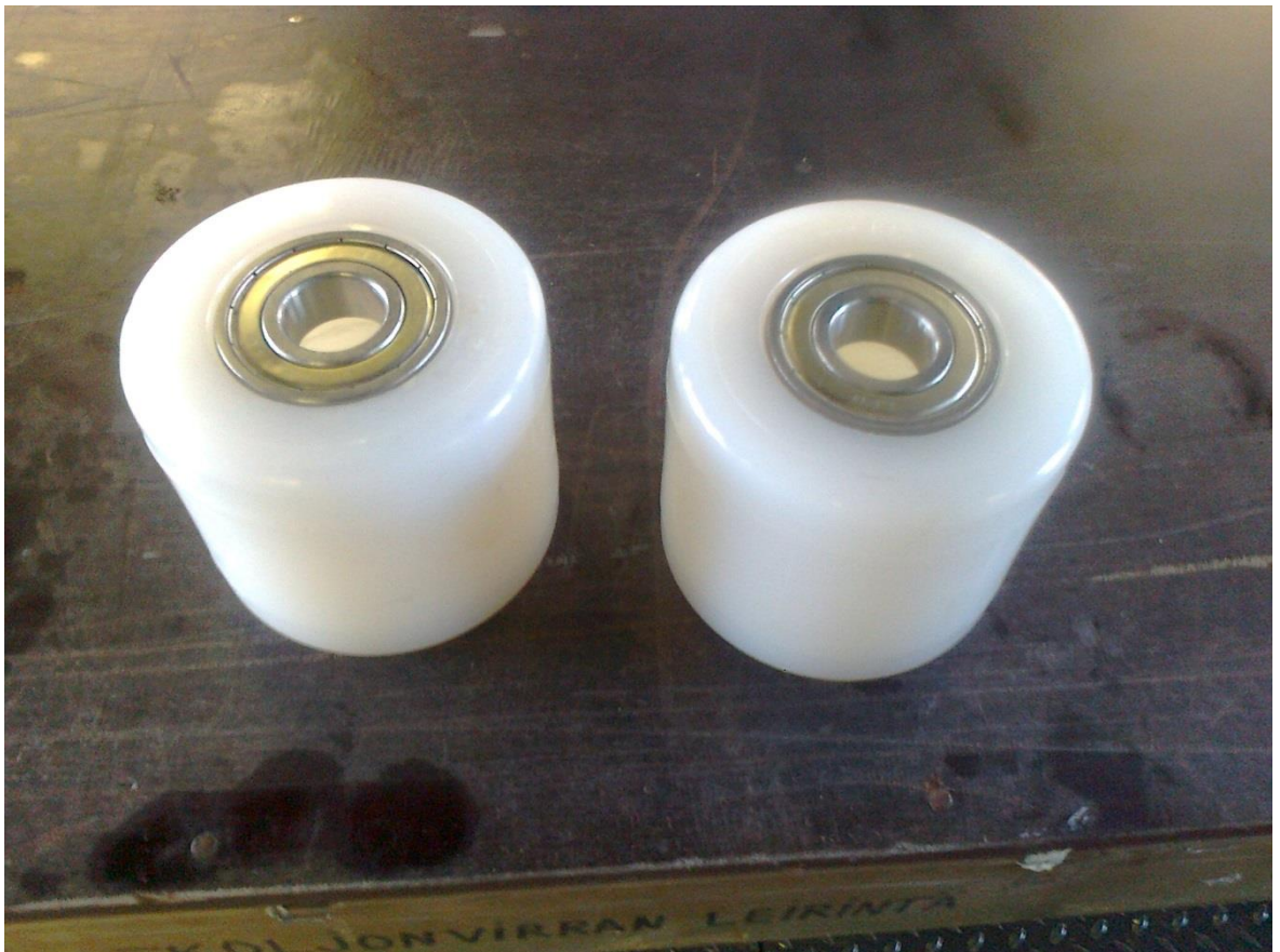
KUVIO 17. Nostimeen asennettavat nailonpyörät
