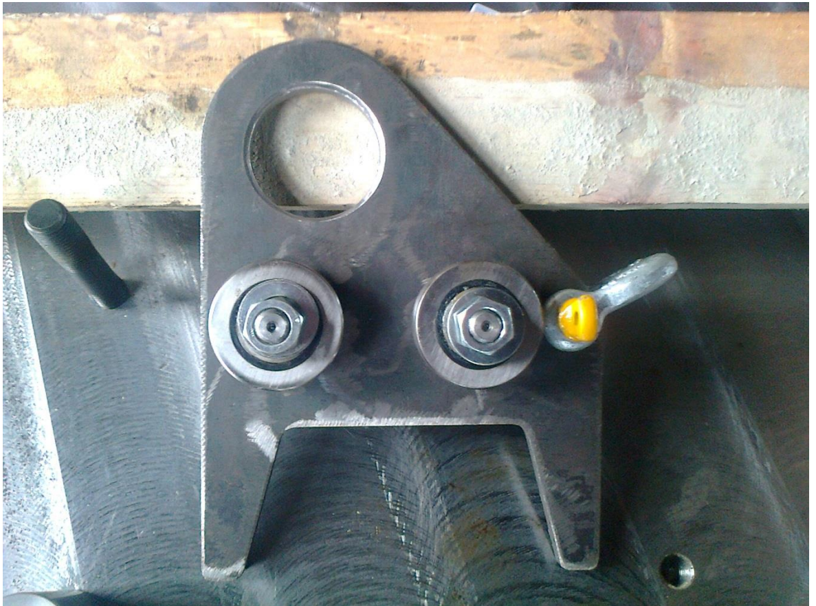
Nostimen kelkka osineen kokoonpantuna
