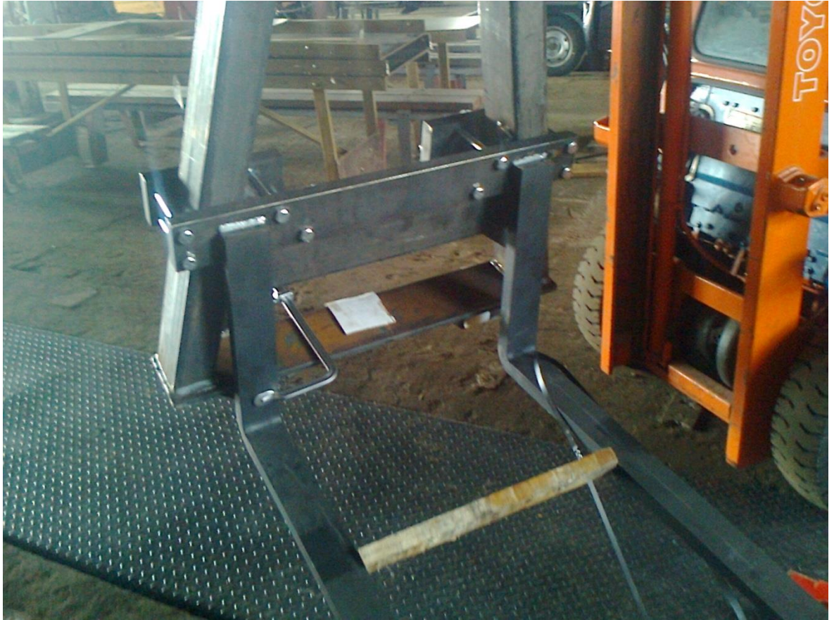
KUVIO 25. Piikit kiinnitettynä nostimen runkoon
