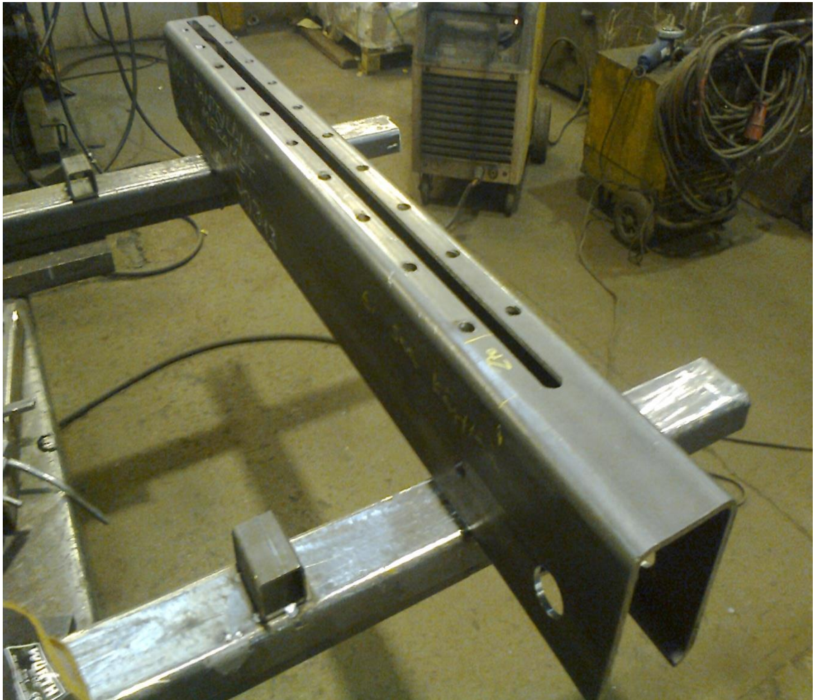
Nostimen puomi määramittaan katkaistuna ja koneistettuna
