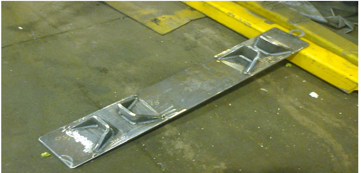
KUVIO 19. Pyörrien rungot hitsattuna alatukilevyyne
