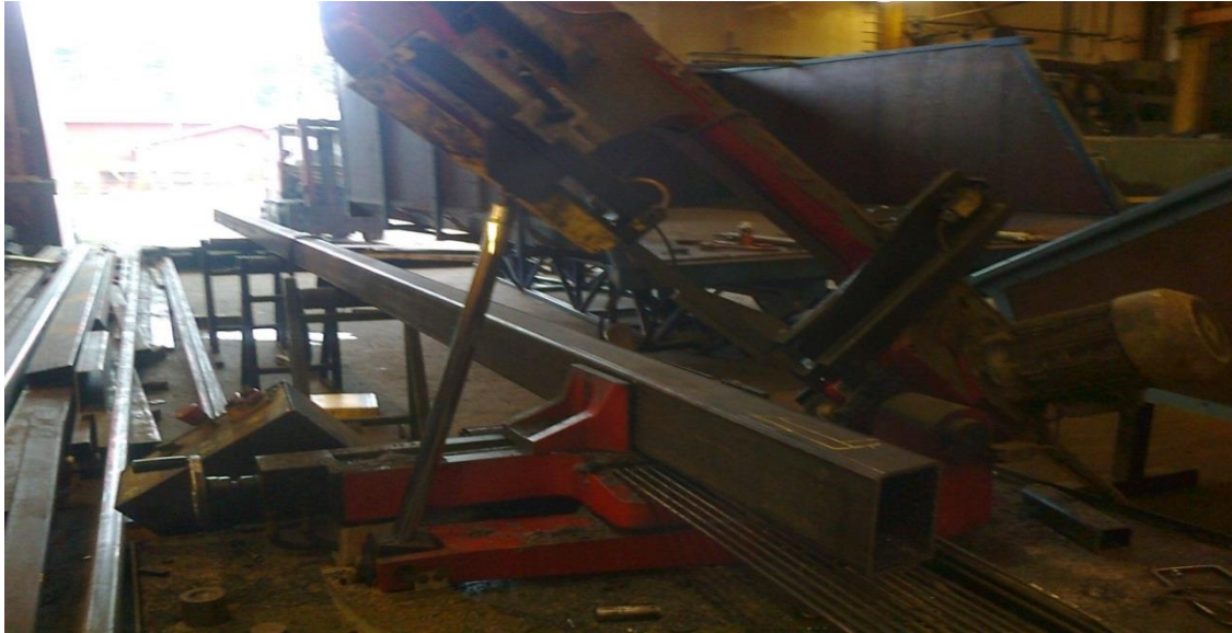
KUVIO 6. Palkkien ja puomin katkaisuun käytettävä saha
