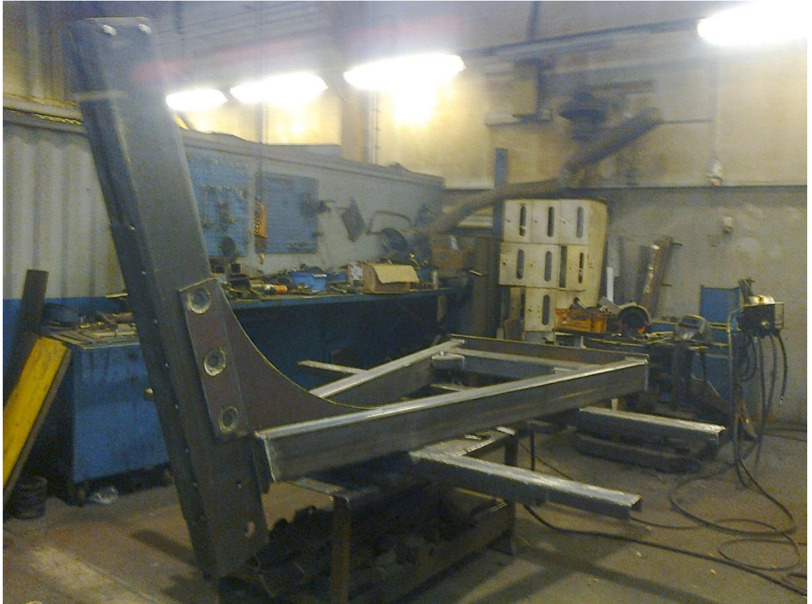
KUVIO 24. Nostimen runko kokoonpantuna
