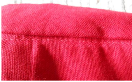
KUVIO 16. Laukun sivusaumasta rakennekuva ja kuva
