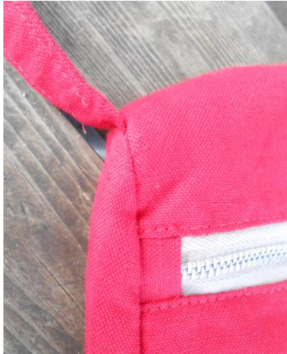
KUVIO 22. Hihna on kiinnitetty suoraan saumoihin
