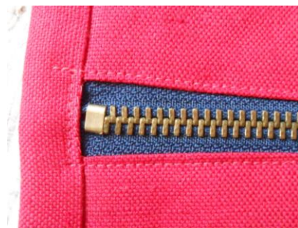
KUVIO 9. Rakennekuva ja kuva taskun sivusaumasta
