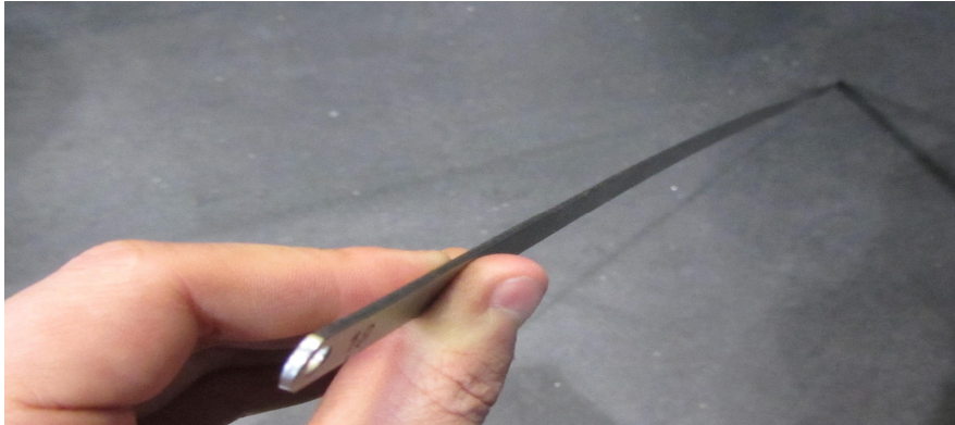
Kuva 6. Ilmavälitulkki on yli metrin pituinen tarkkuushiottu rakotulkki
