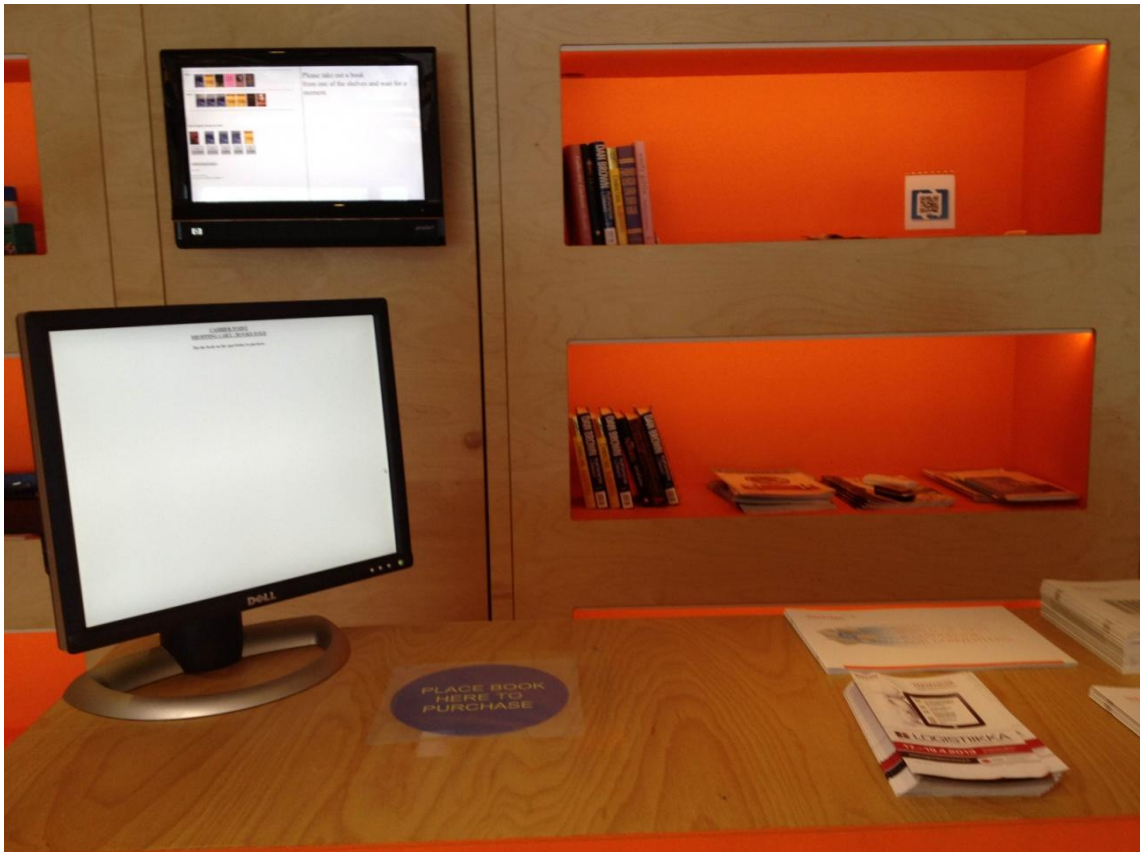
Figur 12. Bilden visar en så kallad smarthylla. Hyllan känner igen alla böcker som där enligt databasen borde finnas.
