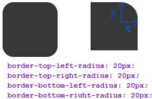
Kuva 11. Div-elementtiin on luotu reunojen pyöristys CSS3:n avulla. Oikealla vieressä suurennos oikeasta yläreunasta, josta nähdään kuinka y- ja x-akselin pisteiden välille piirtyy käyrä, joka luo pyöristyksen.
