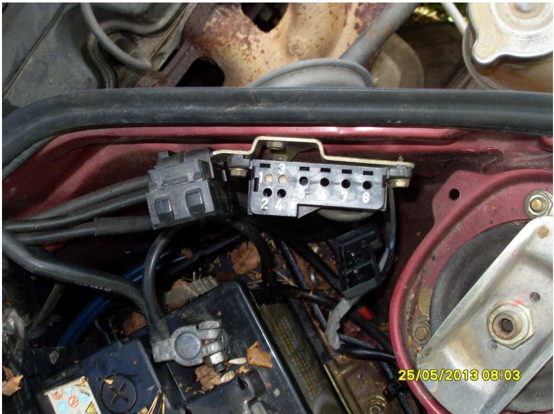
Kuva 2. Liitin W201-korisen Mercedes-Benzin moottoritilassa
