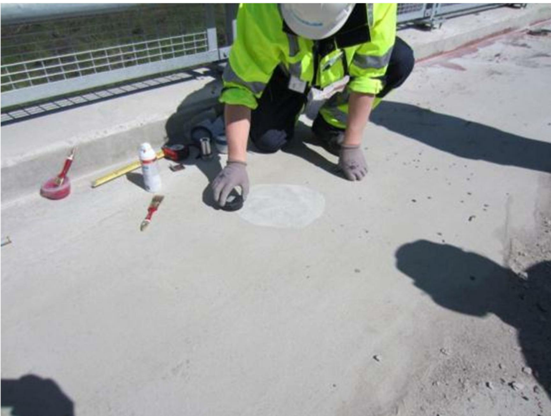
Kuva 11. Lasihelmikoe. Valokuva Marko Savolainen 2012.
