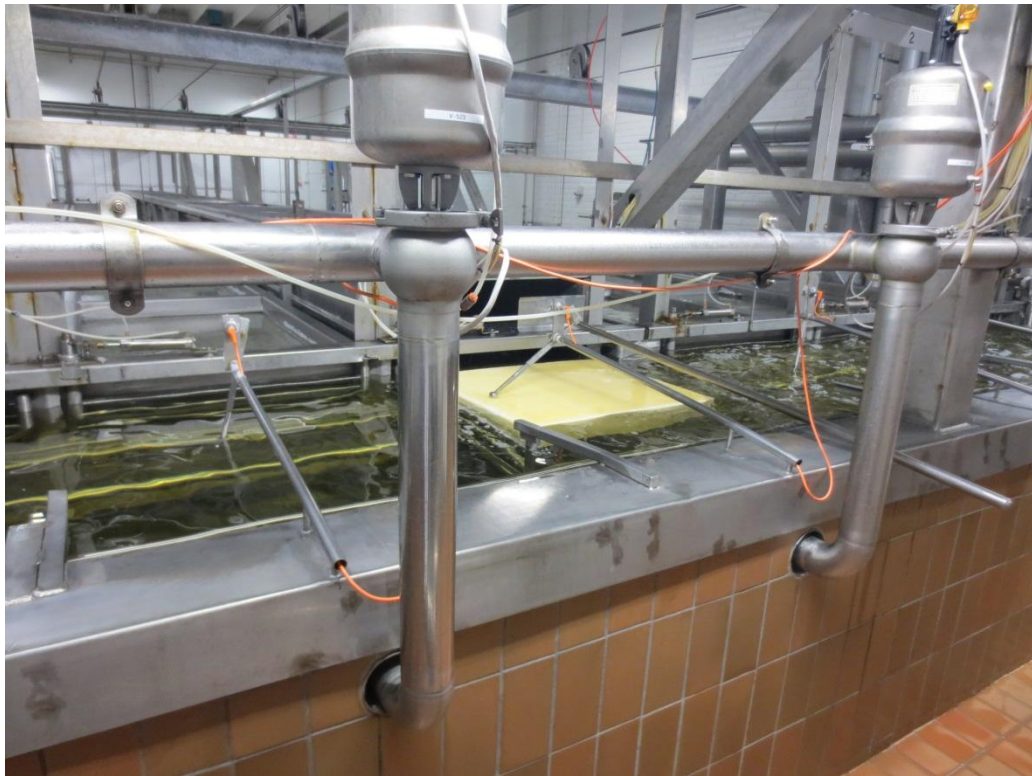
KUVA 3. Emmental-juustoharkko menossa suolaukseen (Lapinlahden Valio Oy, kunnossapitoarkisto 2011.)
