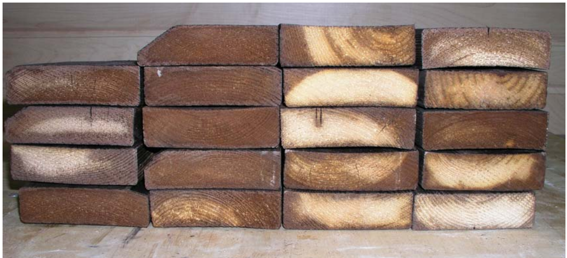
Kuva 2. Visor-käsiteltyjen puutuotteiden suoja-aineen tunkeuman analysointi poikkileikkauksnäytteistä
