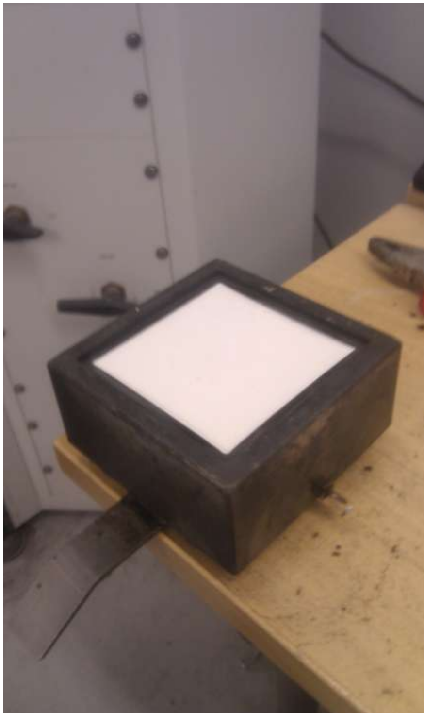
Kuva 8. Koekappale kappaleen pidikkeessä. Kuva Susanna Eskola 2013
