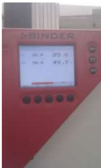
Kuva 7. Tasaannutuskaapin näyttö, josta näkyy suhteellinen kosteus ja lämpötila kaapissa. Kuva Susanna Eskola 2013
