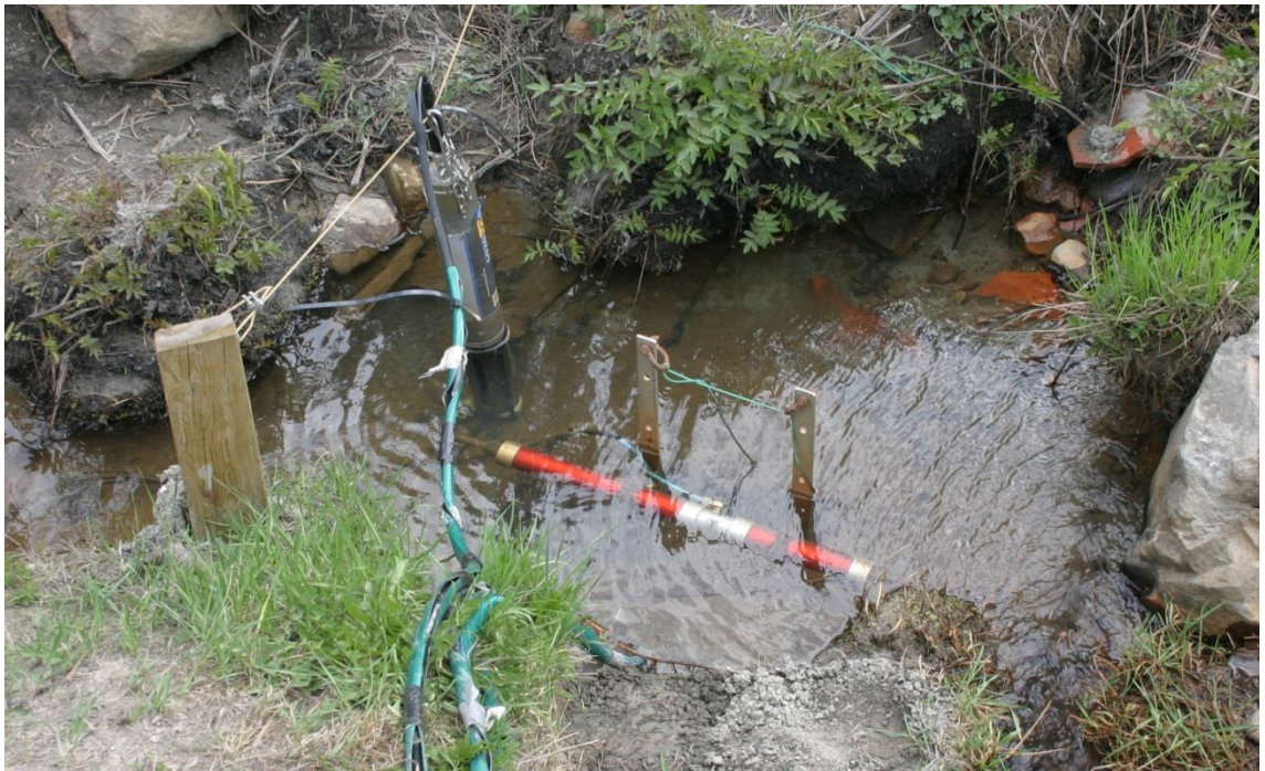
Kuva 8. Vedenlaadun mittarit asennettuina käsitellyn ojaveden mittauspisteeseen. (takana pystyssä YSI 6920 ja edessä punainen S::can nitro::lyser).
