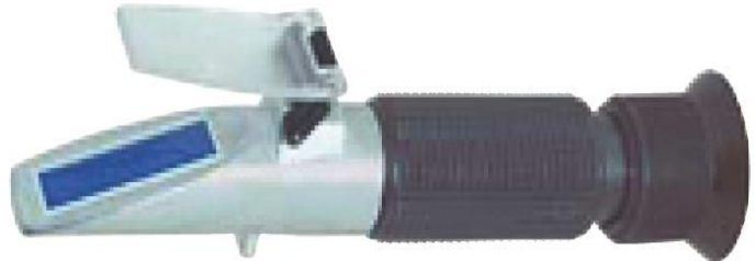
Kuva 11. Refraktometri lastuamismesteen pitoisuuden mittaamiseen.
