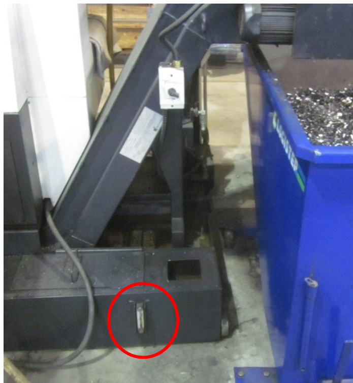
Kuva 6. Lastuamisnesteen tarkastusikkunan sijainti
