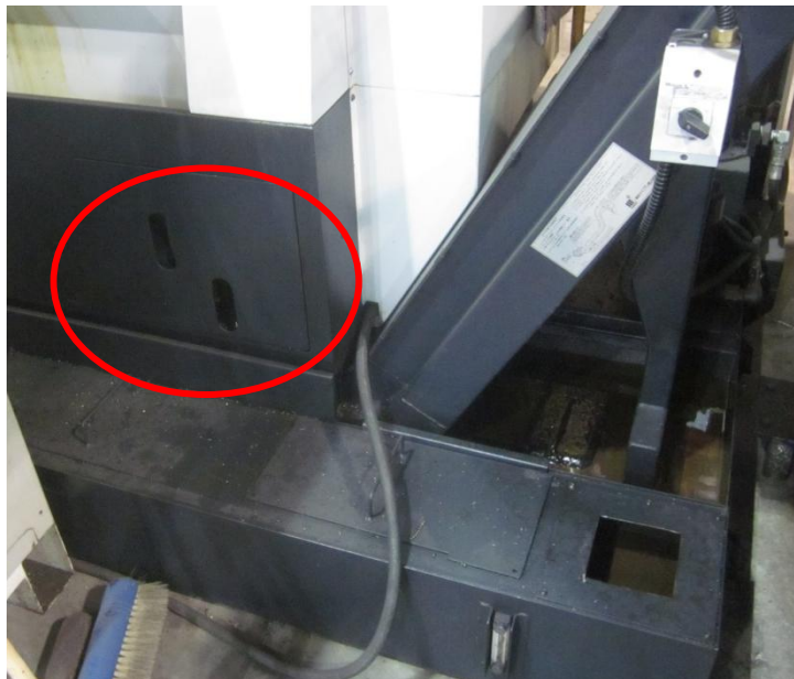
Kuva 5 Keskusvoiteluyksikön tarkastusikkunan sijainti
