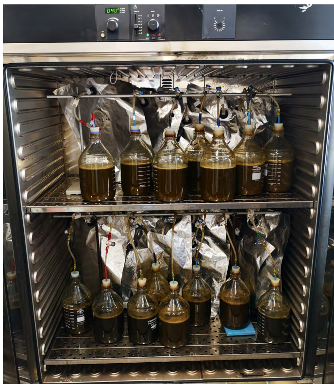
KUVA 1. Pullopanokset lämpökaapissa kaasupussit kiinnitettyinä. (Kuva Jussi Konttila)
