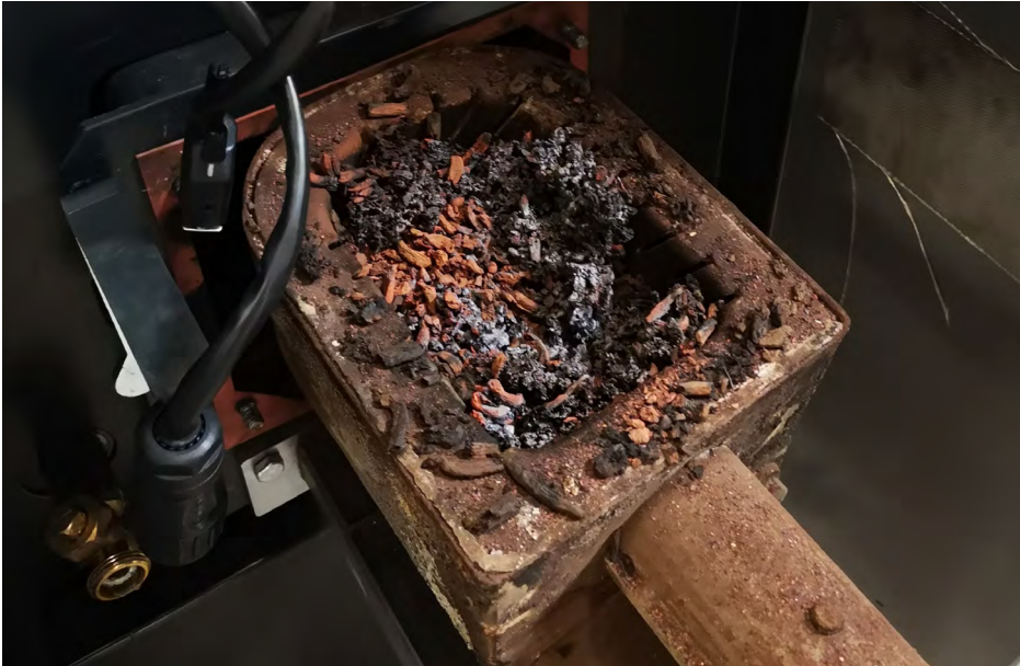
KUVA 4. Hiiltynyttä lietettä polttimen polttokupissa (kuva Jussi Konttila).
