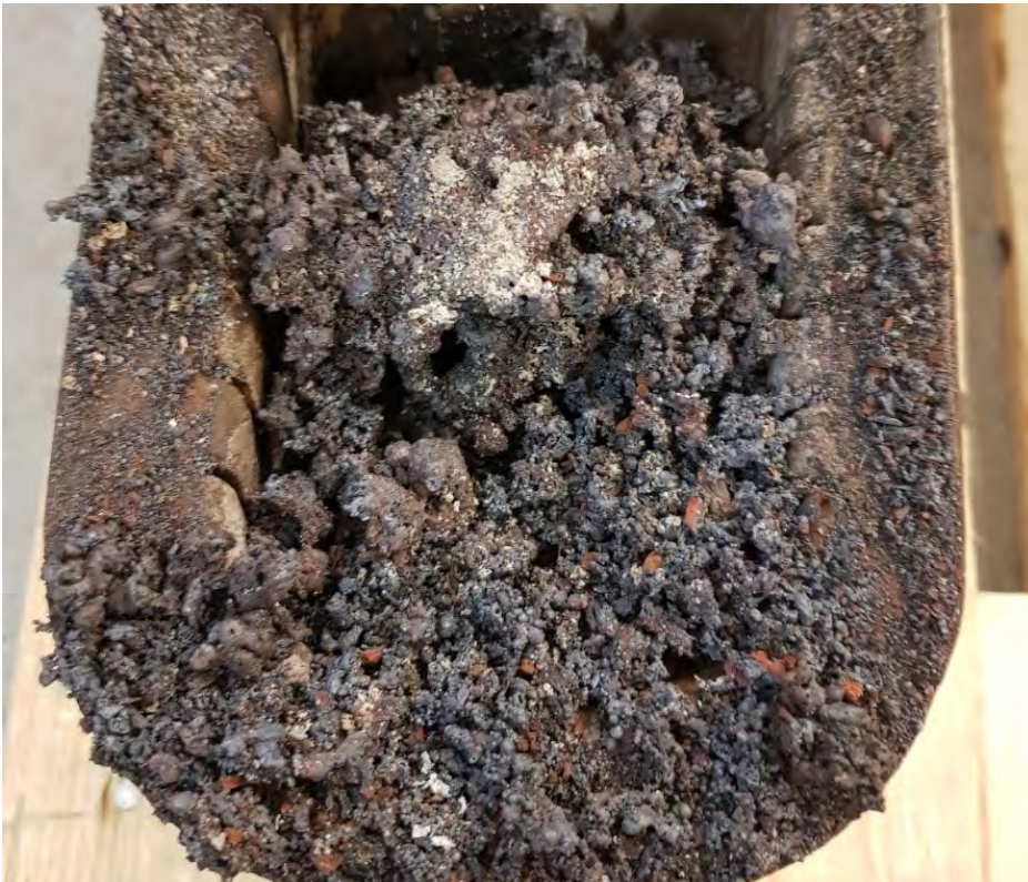
KUVA 7. Sintraantunutta liete-puupellettiseosta polttokupissa (kuva Salla Pulliainen).
