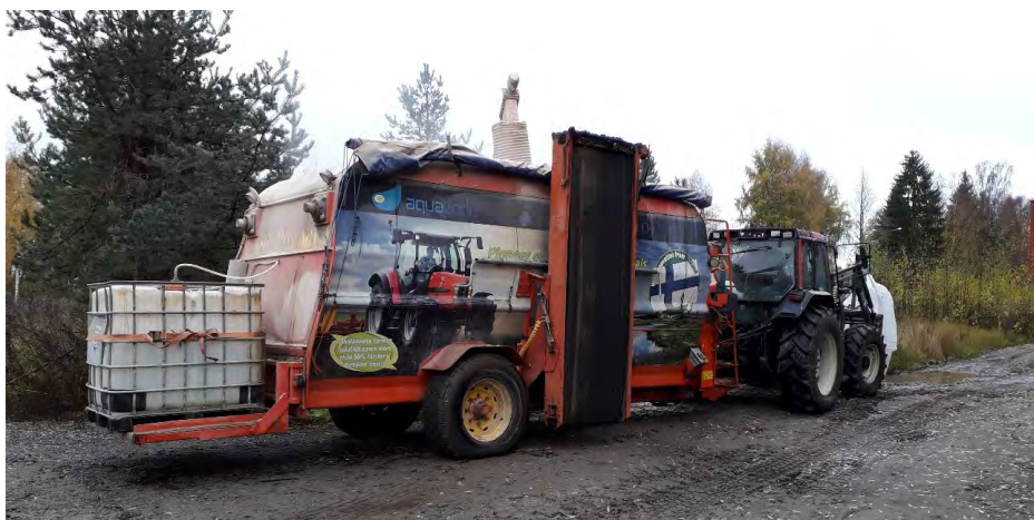
KUVA 1. Kalkki ja peretikkahappo sekoitetaan lietteeseen lietevaunussa (kuva Salla Pulliainen).
