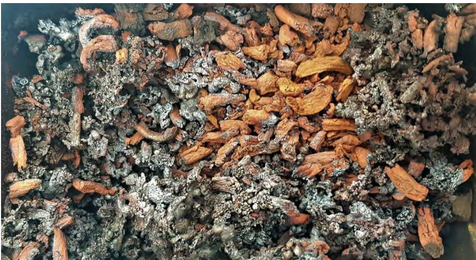
KUVA 5. Sintraantunutta ja palamatonta lietettä (kuva Salla Pulliainen).
