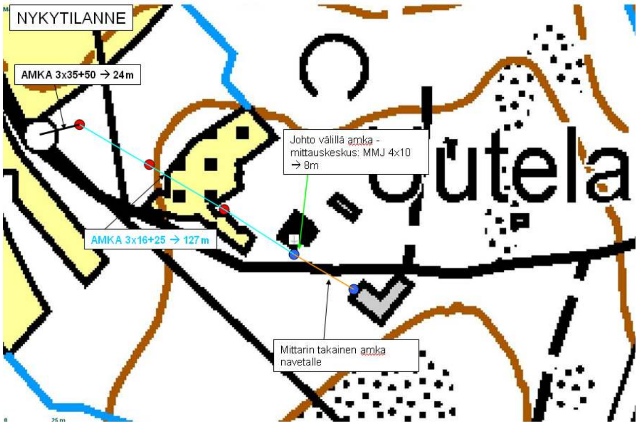
Kuva 1. Sähkön syöttö talolle, nykytilanne
