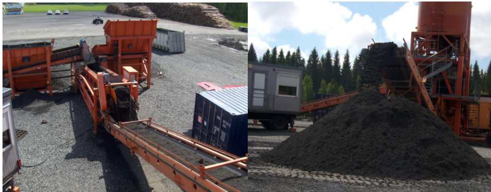
Kuva 5. Tuhka kuljettimelta sekoittimelle ja valmis tuhkaseos oikealla.
