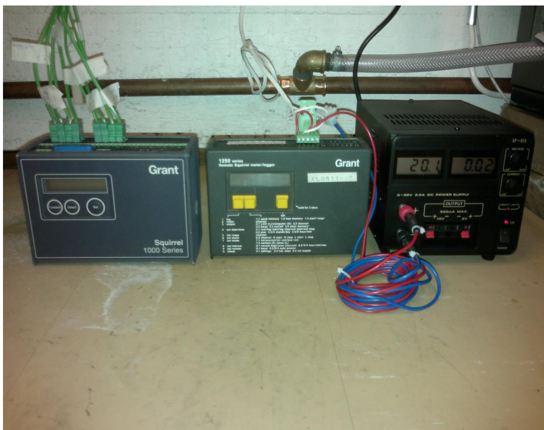
Kuva 11. Paine-erolähtettimen ulkoinen virtalähde kytkettynä dataloggeriin.
