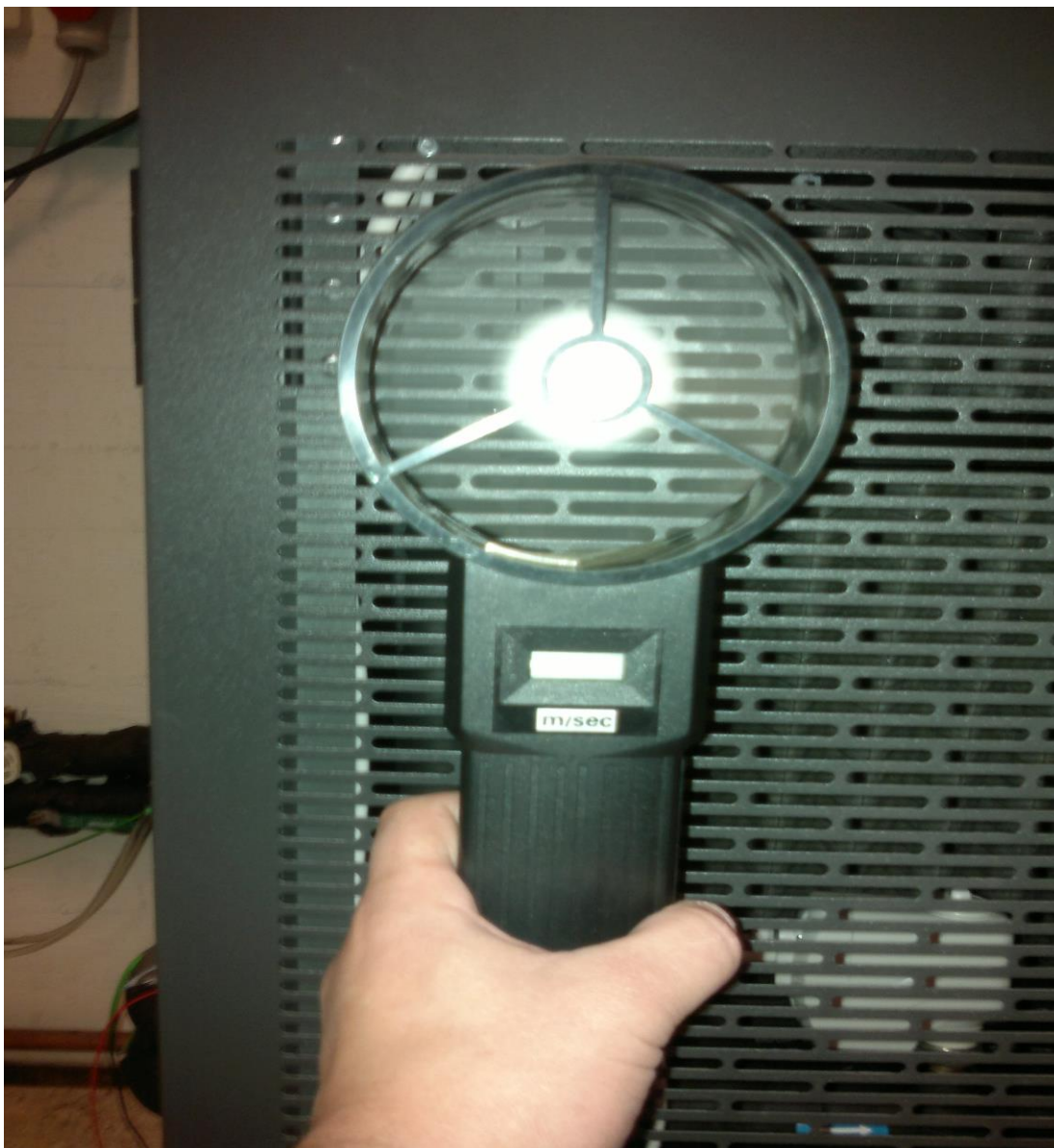
Kuva 10. Kaappikoneen imuaukon ilmavirranmittaus siipipyöränemometrillä
