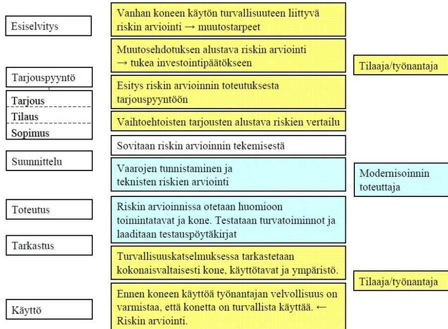
Kuva 6. Tavalliset riskin arviointiin liittyvät toimenpiteet modernisointiprojektin eri vaiheissa. Oikeassa reunassa on mainittu taho, joka on tavallisesti vastuussa tehtävästä.
