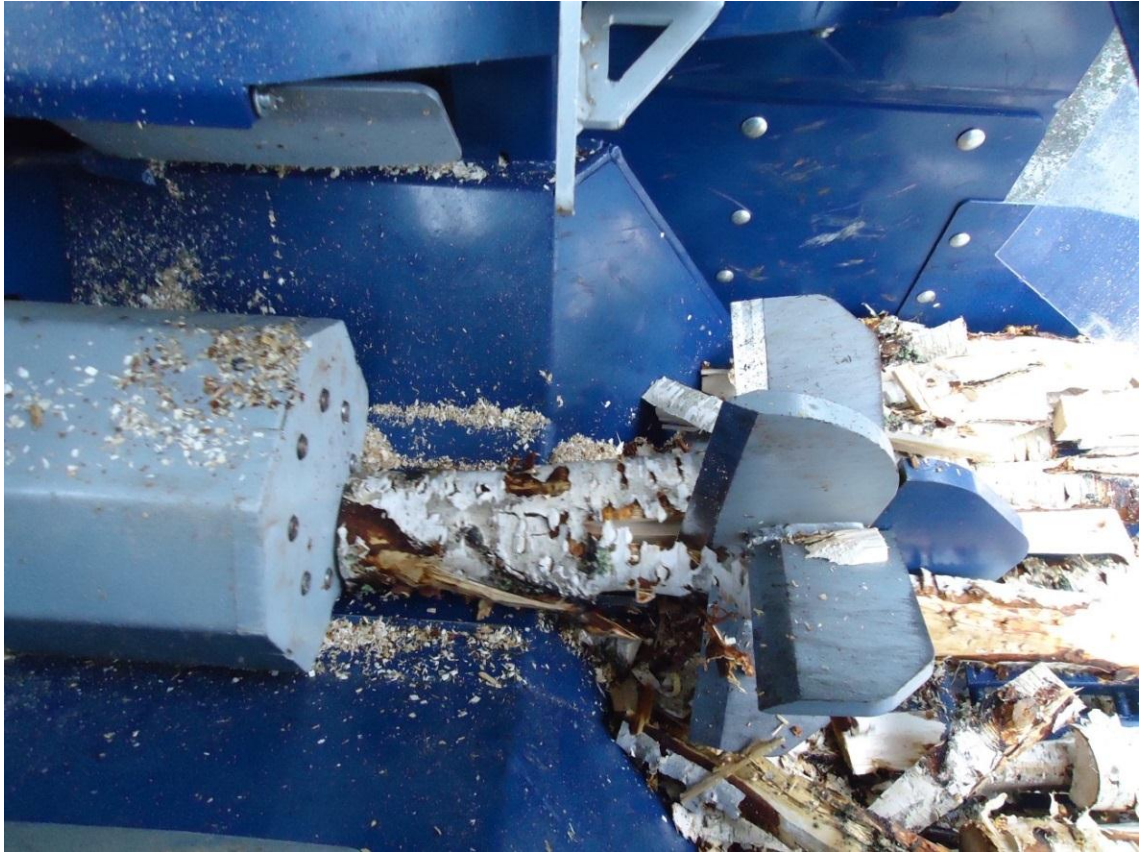
Kuva 5. Katkaisu-halkaisulaitteen halkaisuvaihe (Kuva: Tommi Karukannas.)
