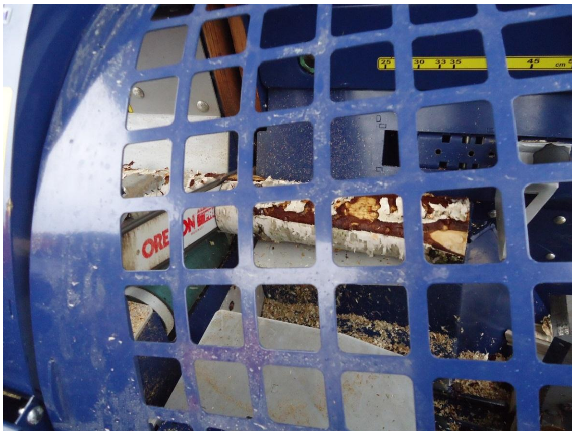
Kuva 5. Katkaisu-halkaisulaitteen sahausvaihe. (Kuva: Tommi Karukannas.)
