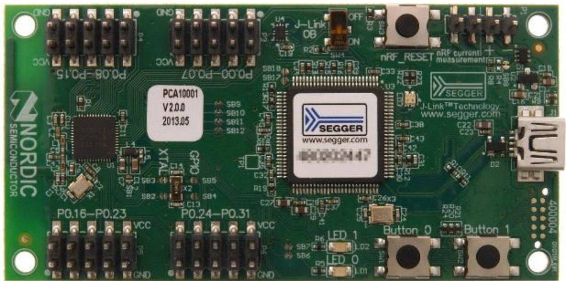
Kuva 8. Nordic Semiconductor nRF51822 Evaluation Kit -kehitysalusta [48, s. 4]
