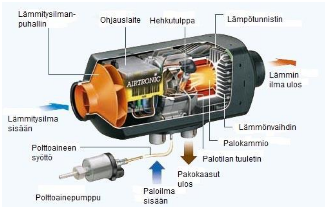
KUVA 7. Ilmalämmittimen rakenne (8)
