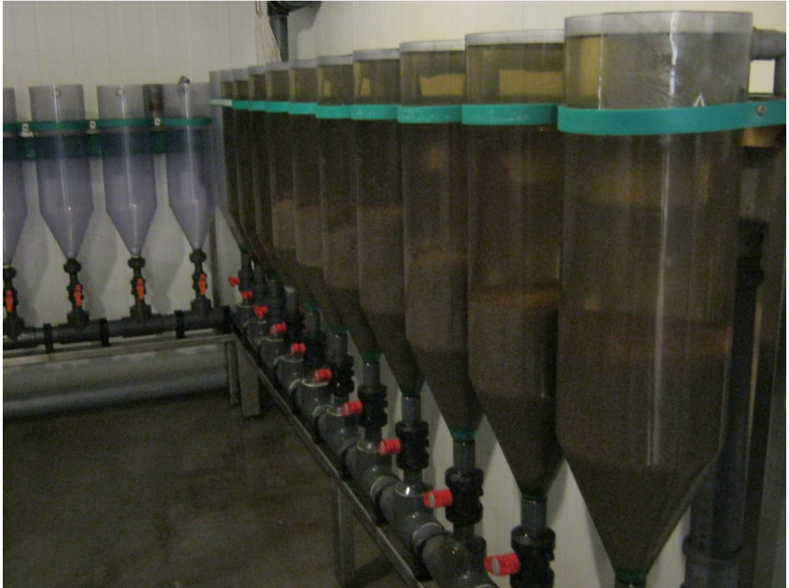
Kuva 7. Täytettyjä haudontasuppiloita. Mätää on vain alle puolen välin, jotta mäti ei leijuisi pois suppilosta. Kuva RKT:n Keminmaan laitokselta.
