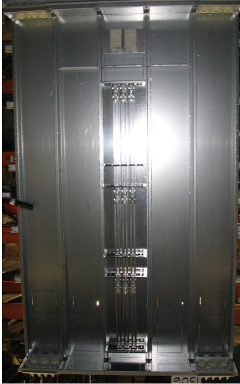
Kuva 4.1. Keskuksen messumalli. Takalevyt, päädyt ja kiskosto kasattuna.
