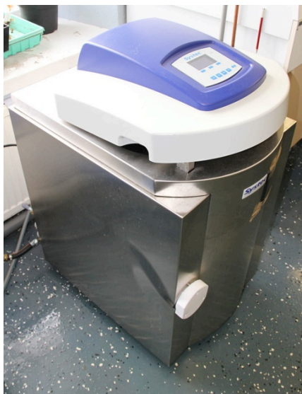
Kuva 2. Autoklaavi eli painekeitin, jossa sterilointi tehdään kuuman höyryn ja paineen avulla. Autoklaavissa voidaan steriloida kuumentamisen kestäviä kemikaaleja, kasvatusalustoja, viljelyastioita ja instrumentteja. Sterilointilämpötila vaihtelee 110-130°C välillä. Sterilointiaika on riippuvainen esim. steriloitavasta määrästä. (Haapala & Niskanen 1992, 30.)
