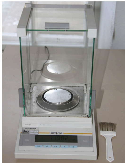
Kuva 4. Tarkkuusvaaka kemikaalien punnitsemiseen. Tarkkuudeltaan vaa'an tulee olla 0,1 grammaa. Sokeria, agaria ja aktiivihiehtä käytetään suuria määriä alustoissa ja nämä pitää punnita. (Haapala & Niskanen 1992, 30.)
