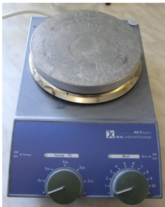
Kuva 5. Lämpölevy tai mikroaaltouuni. Kasvatusalustaan tarvittaessa lisätään agar, jolloin alustaa joudutaan kuumentamaan. (Haapala & Niskanen 1992, 30).
