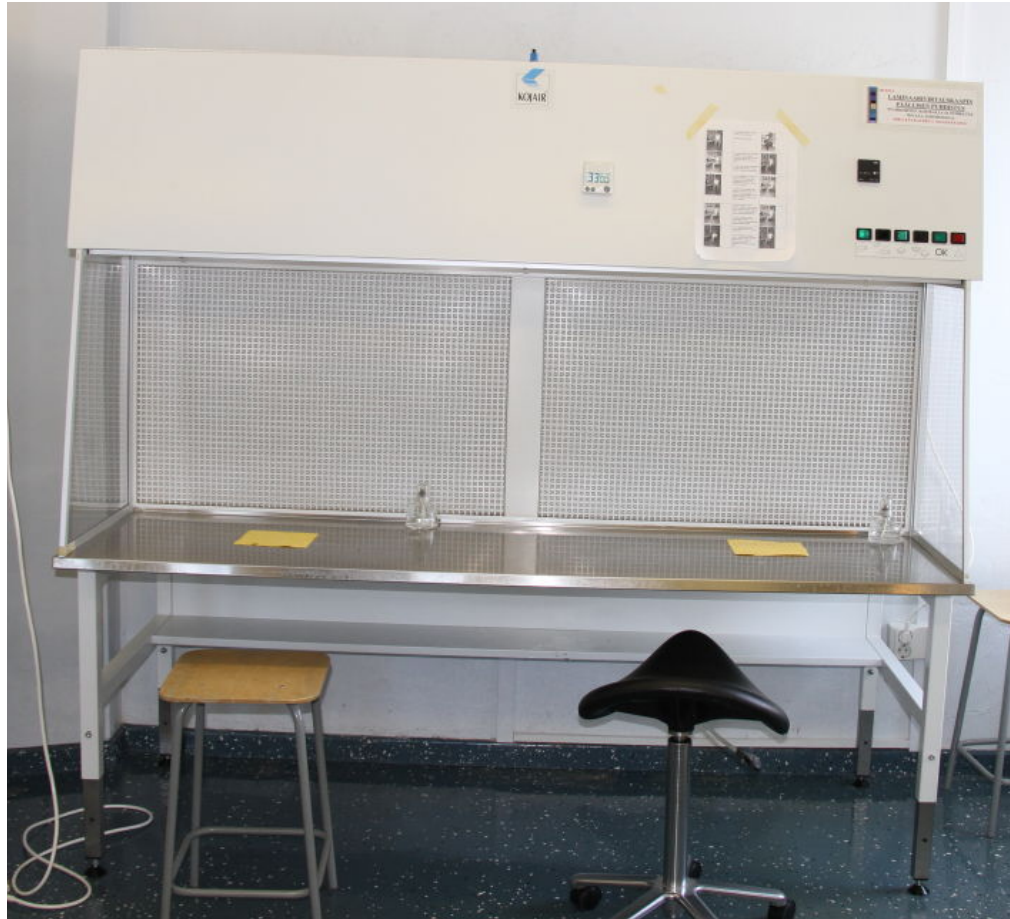
Kuva 1. Laminaarivirtauskaappi on steriili työskentelytila. Kaappeja on kahta perustyyppiä: toisessa suodatetaan ilmavirtaa vaakasuorassa työntekijää kohti tai toisessa ilmavirtaa suodatetaan ylhäältä alas. Yleisemmin mikrolisäyksessä käytetään kaappia, jossa suodatettu ilmavirta kulkee peräseinästä kohti työskentelijää. Näin estetään partikkelien siirtymisen ilmavirtaa vastaan. (Haapala & Niskanen 1992, 30.)
