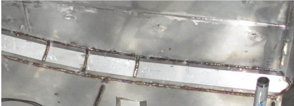
KUVA 9. Muotoon pakotettu reunalevy.
