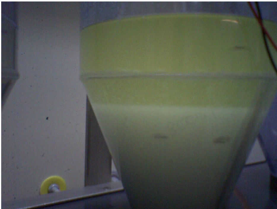
Kuva 6. Kuplituspesun jälkeinen biodieselin ja pesueden rajapinta.
