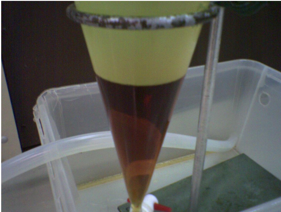
Kuva 5. Vuorokauden erottumisen jälkeen biodieselin ja glyserolin rajapinta on selvästi havaittavissa.
