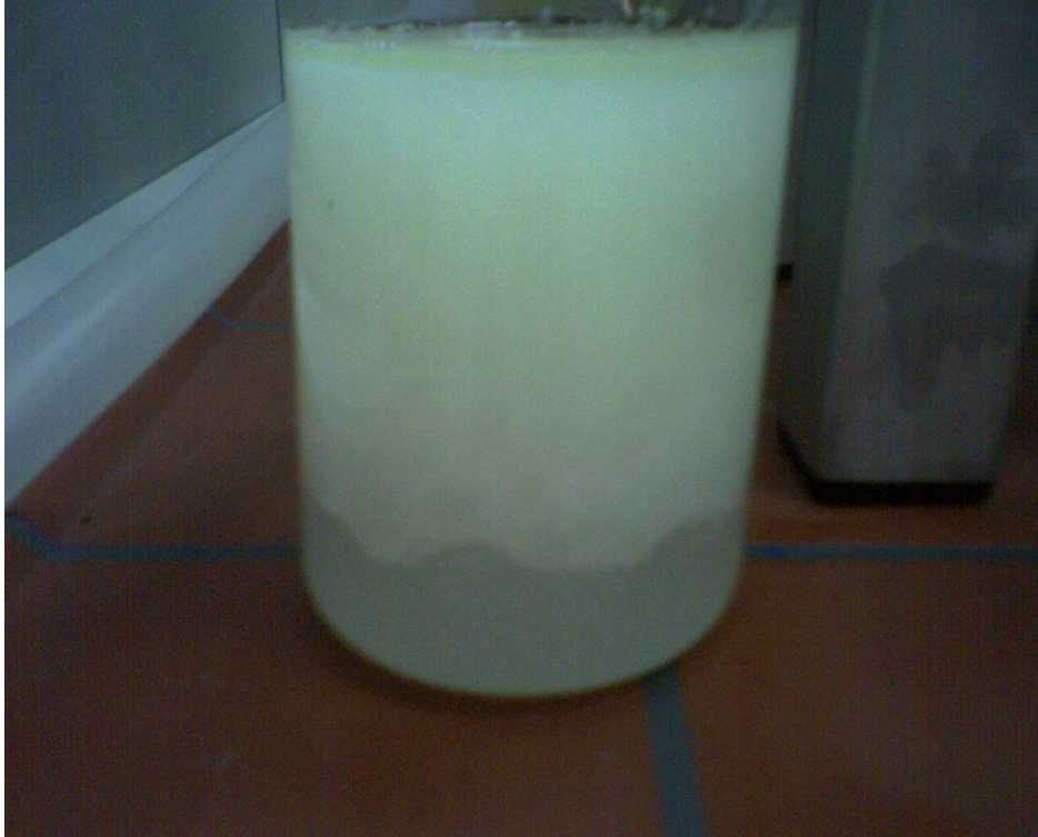
Kuva 8. Biodieselin pesuveteen muodostunutta saippuaa ja emulsiota.
