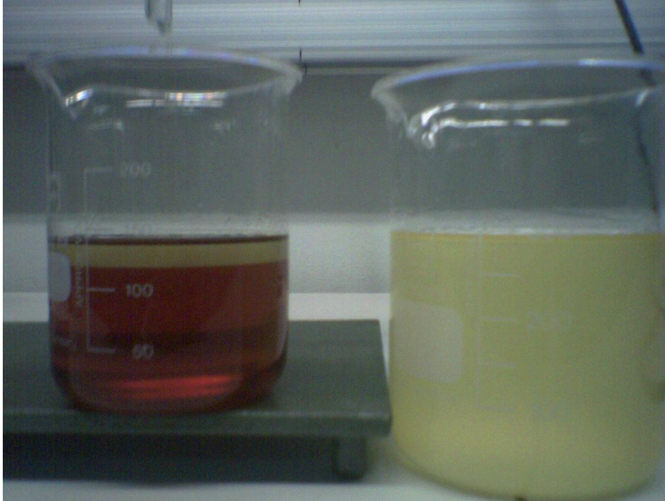
Kuva 4. Vaihtoesteröintireaktiossa syntynyt glyseroli ja pesemätön biodieselnäyte.
