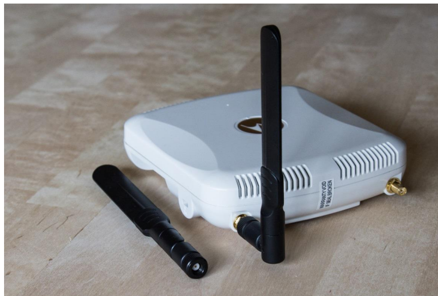
Kuvio 3. Tukiasema AP-6521 ja ML-2452-APA2-01-dipoliantennit.
