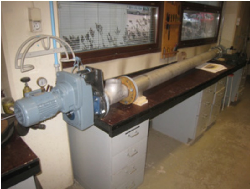
Kuva 4. Ruuvivaiheen testausta konetekniikan laboratoriossa
