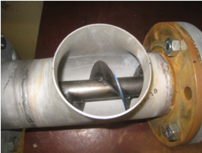
Kuva 5. Ruuvikuljetin putken sisällä
