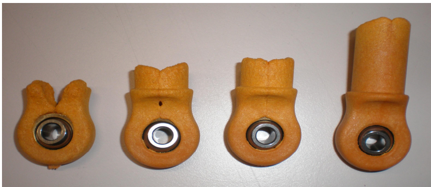
Kuva 14. Vajailta täytöksillä voidaan tarkastella muottipesän täyttymistä
