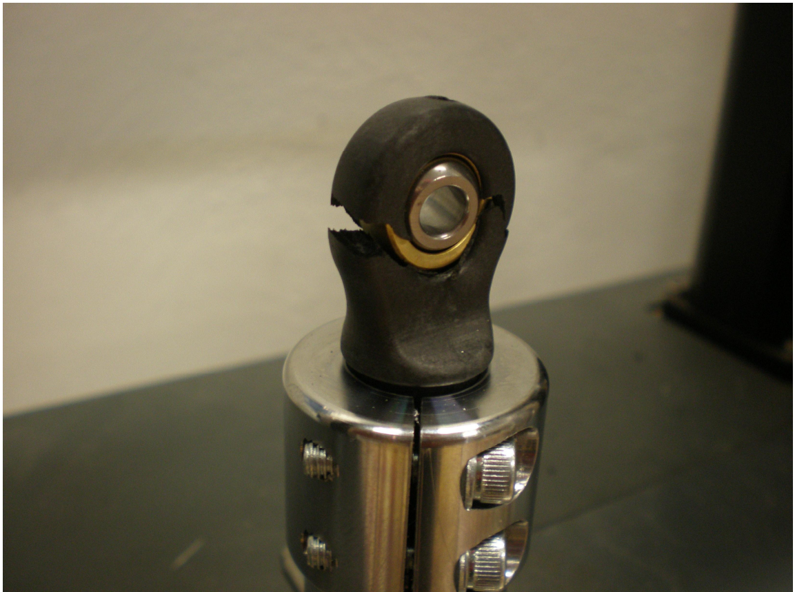
Kuva 20. Rikki vedetty tukivarsipää vetokoneessa
