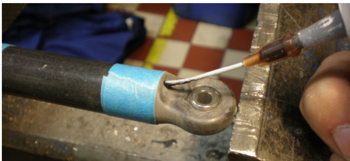
Kuva 19. Vetokoesauvan liiman injektointia
