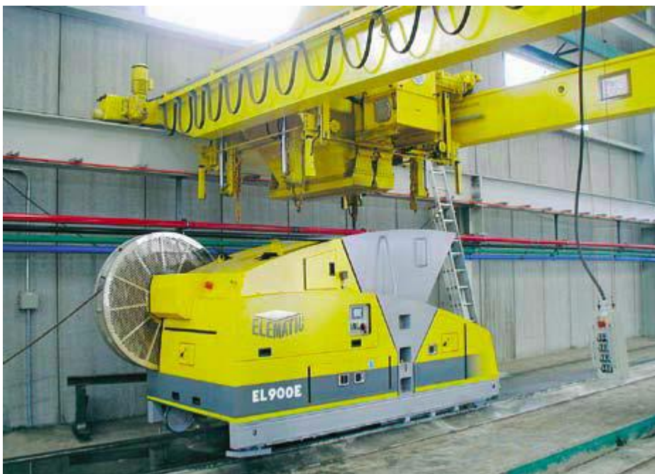
Kuva 1. Extruder-valukone. Yllä betonimassan annostelija [4, s. 14]
