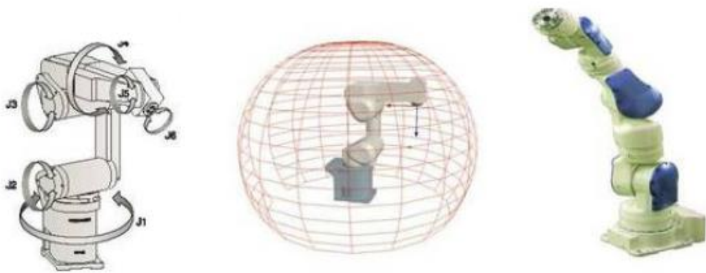
KUVIO 18. Kiertyvänivelinen 6- ja 7-akselinen robotti ja työalue (Billing 2012, 9)
