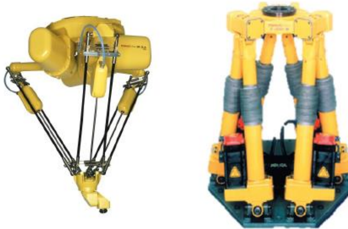
KUVIO 20. Kaksi rinnakkaisrakenteista robottia, kevyt vasemmalla puolen, raskas oikealla puolen (Billing 2012, 9)
