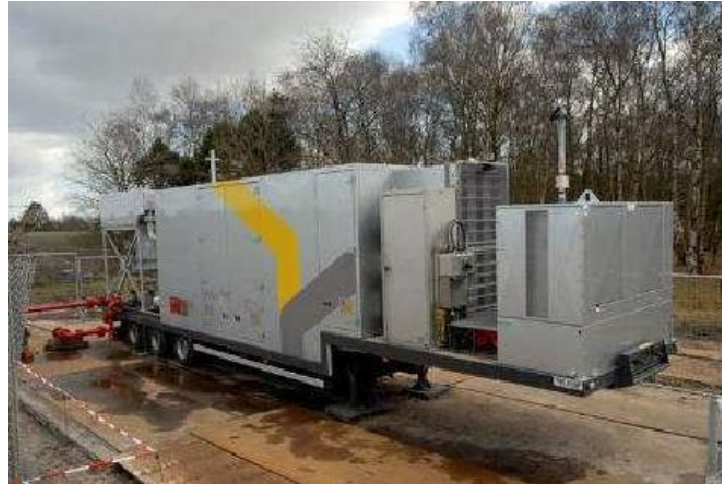
Kuva 13. Esimerkki liikuteltavasta kompressoriyksiköstä [Transmission 2009: 16].
