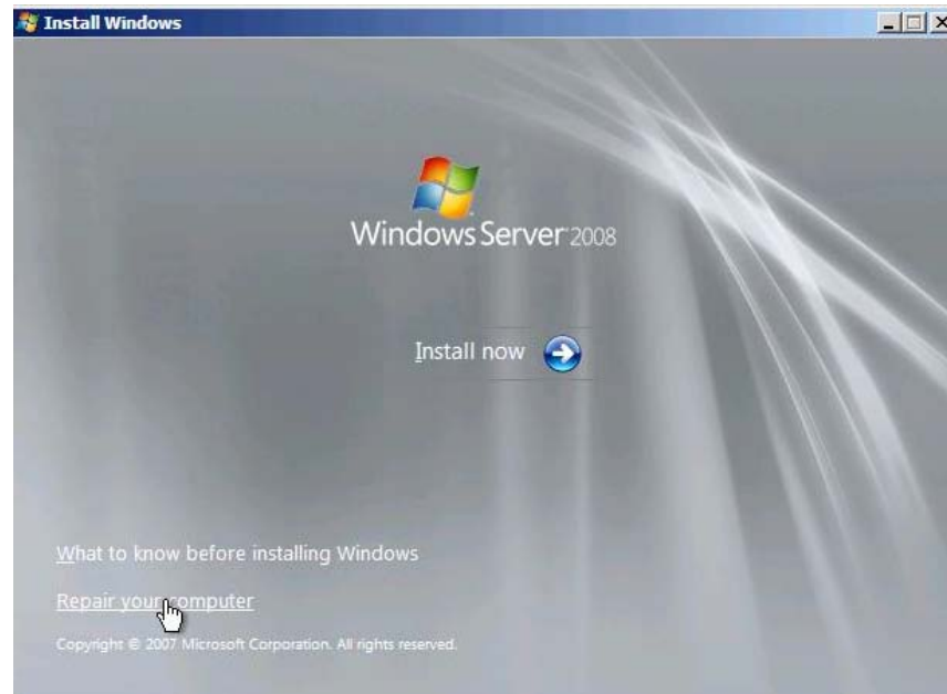
Kuva 29 RE:n käynnistäminen asennuslevyltä.
