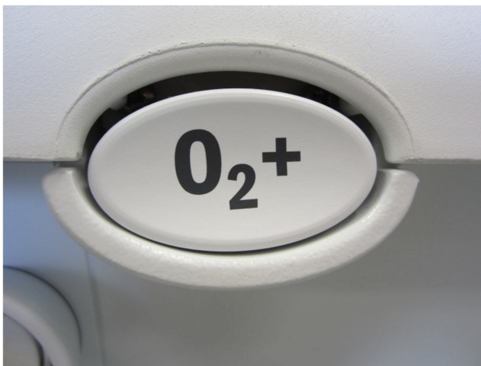
KUVA 3. Happihuuhteluventtiili, ns. hätähappi-painike (Siru Lampainen & Katri Manninen 2013)
