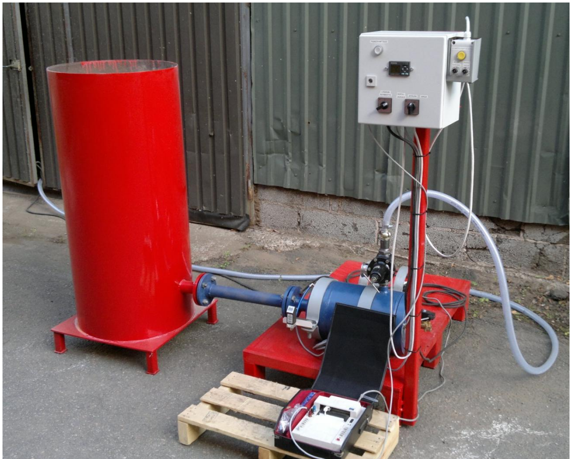
KUVA 14. Siilotykin testauslaitteisto valmiina koeammuntaan (Kuva: Janne Isomettä 2013)
