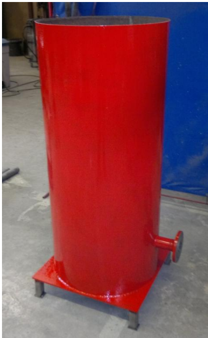
KUVA 6. Valmis hiekkasäiliö maalauksen jälkeen (Kuva: Janne Isomettä 2013)
