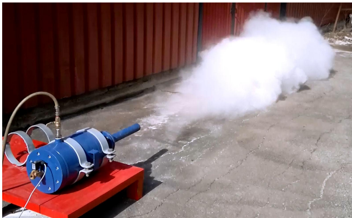
KUVA 16. Siilotykin laukaus. Väriaineena kalkkijauhe (Kuva: Janne Isomettä 2013)
